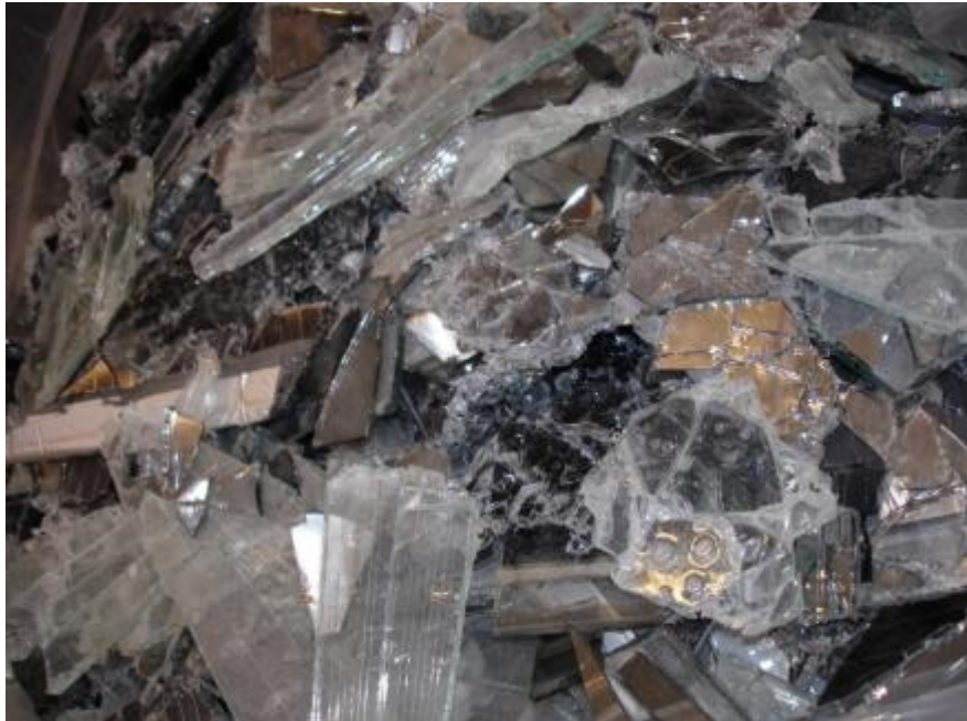
Figure 3-4: Breakage of CIS module (Bundesanstalt für Materialforschung und -prüfung, 2007)
