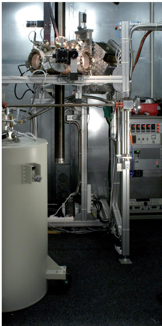
**Abbildung 4.2:** Fotografische Außenansicht von Vakuumsystem und Dewar-Gefäß des Tieftemperatur-Rastersondenmikroskops. In der Mitte oben ist die Vakuumkammer mit den UHV-Bälgen, am linken Bildrand ist das Dewar-Gefäß zu sehen. Das Dewar-Gefäß wird zum Betrieb unterhalb der Vakuumkammer angebracht, so dass der untere UHV-Balg in das flüssige Helium abgesenkt werden kann (Fotografie von K. Wiedenmann).
