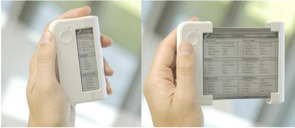
Abbildung 2.10: Rollbarer Bildschirm der Firma Polymer Vision (Foto: Polymer Vision).
