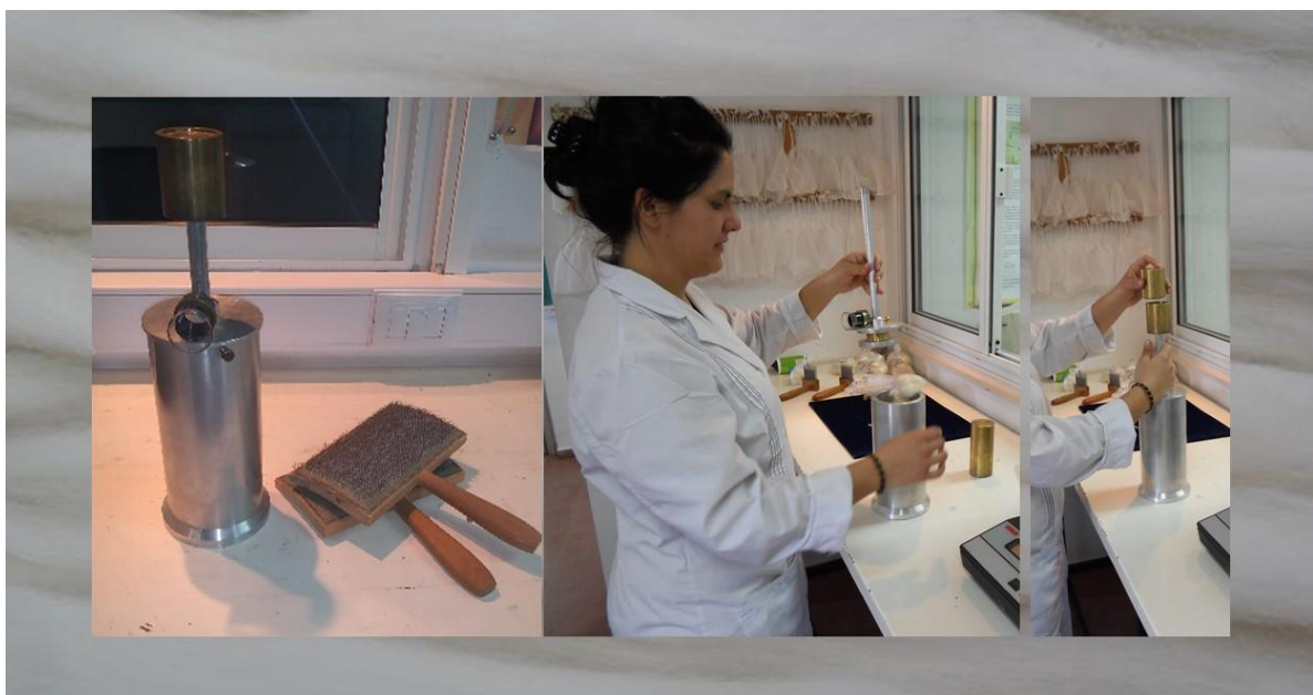
Figura 17: Equipo Bulkómetro y determinación de la Voluminosidad (BK, \text{cm}^3/\text{g} ) y la Resiliencia (RE, \text{cm}^3/\text{g} ) (Hick, 2018)
