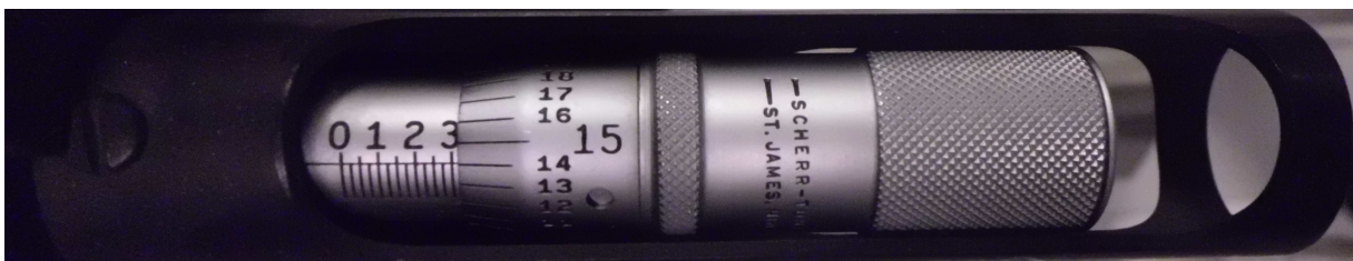
Abbildung 10: Spindeleinstellung 0,314 an der Ulbricht - Kugel
