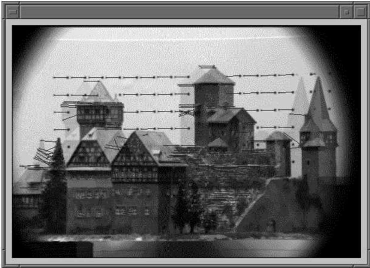
Abbildung 8.62: Überlagerte Bilder zweier Kameras mit Verschiebungsvektoren
