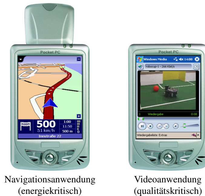
Abbildung 1.2: PDA mit integriertem GPS-Empfänger und dynamischer Leistungsanpassung
