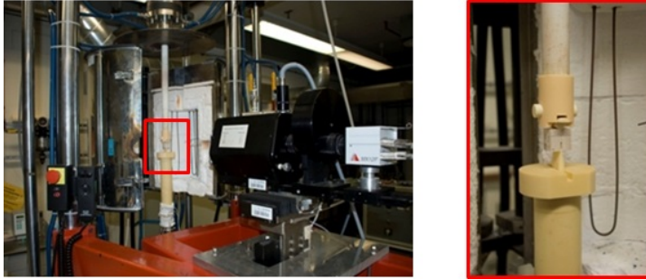
Abbildung 62: Versuchsaufbau für den Keilspalttest bei erhöhten Temperaturen mit Detailansicht.
