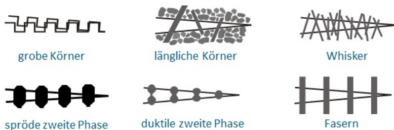
Abbildung 29: Rissverstärkungsmechanismen im Rissflankenbereich [69].
