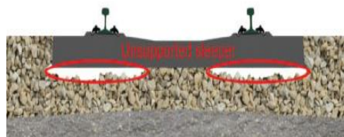
Slika 3 – Praznine u zastoru ispod pragova [9]
