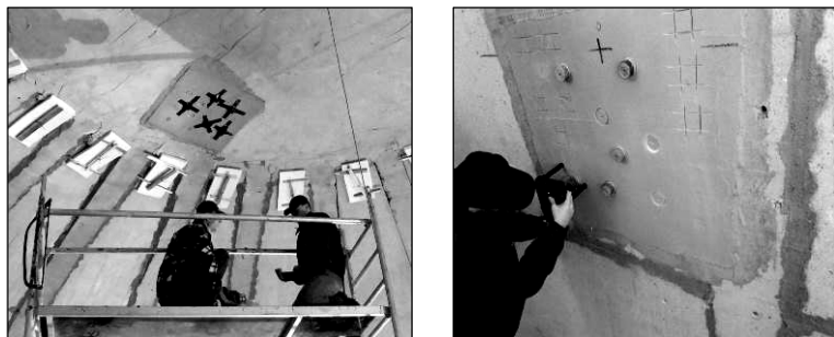
Slika 3. Ispitivanje adhezije IN SITU-na kupoli hrama: probno polje na vrhu kupole (levo), probno polje u podnožju kupole tokom izvođenja opita (desno)
