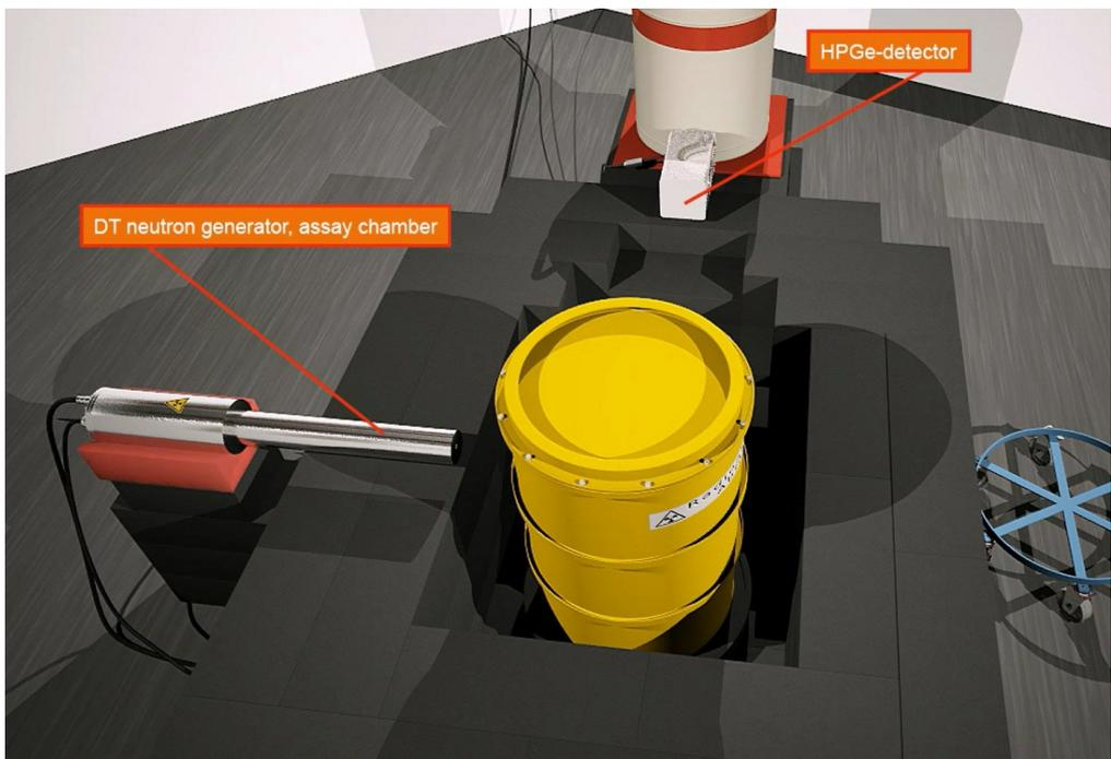
**Abb. 5.5:** Positionierung von Neutronengenerator und HPGe-Detektor in der MEDINA-Bestrahlungskammer /5-17/.
