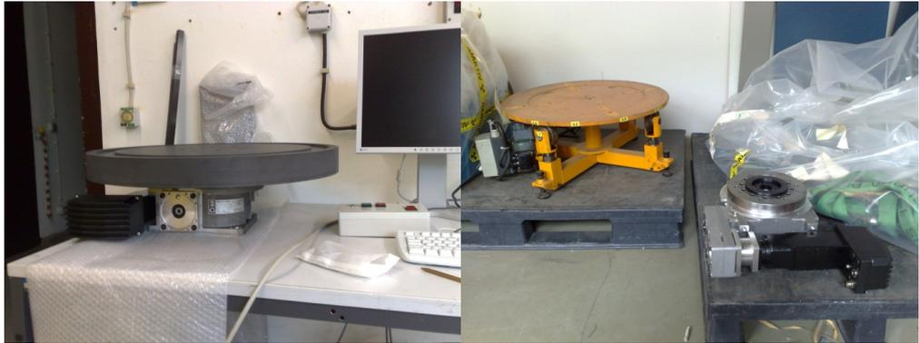
**Abb. 5.11 Links:** Rundschtaltisch der Firma Fibro GmbH mit Zusatzschaltteller aus CFK (Durchmesser 64 cm). **Rechts:** Vergleich zwischen einem Standardrundschtaltisch mit metallischem Fassdrehteller und einer Masse von 90 kg und dem bei MEDINA verwandten Kompaktsystem mit den äußeren Abmessungen 43 cm · 42 cm · 15 cm und einer Masse von 28 kg.
