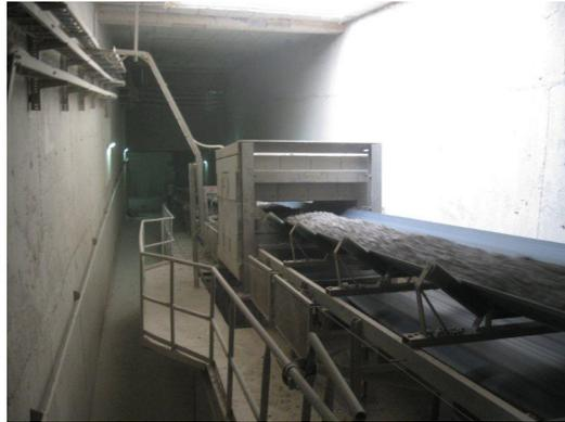
**Abb. 3.9:** Echtzeitanalyseverfahren der Firma Thermo Fisher Scientific Inc. zur Elementaranalyse von Erzen auf Förderbändern mit der Modellbezeichnung: Thermo Scientific CB Omni, Cross-Belt Elemental Analyzer for the Mining Industry Omni /3-16/.
