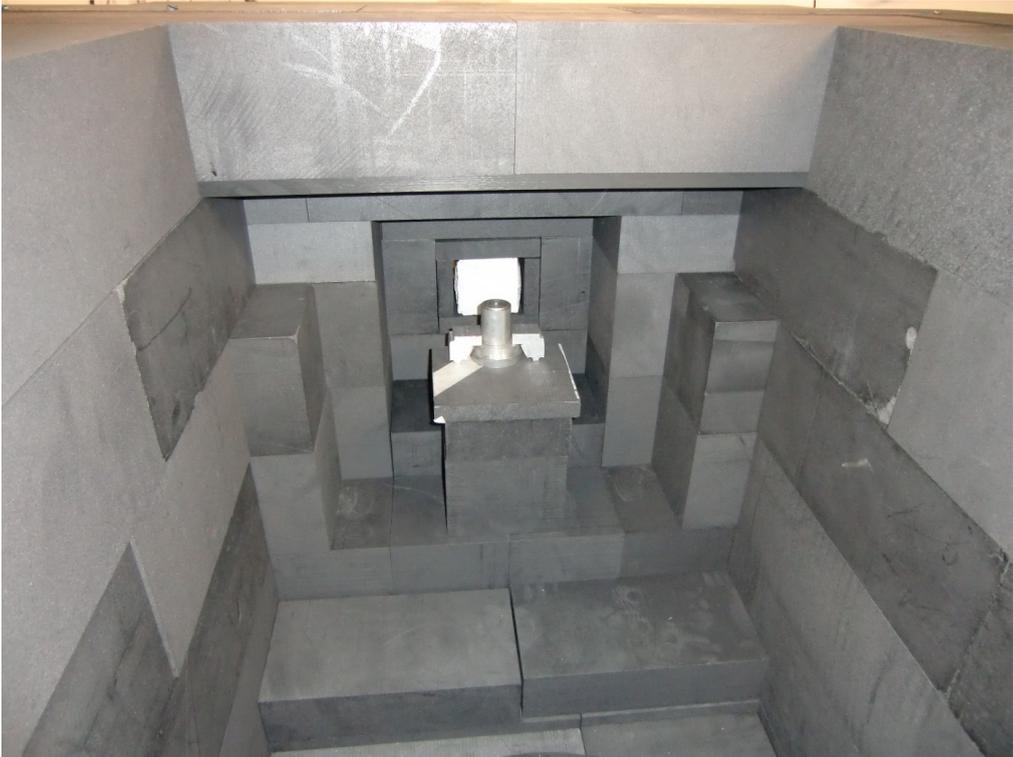
**Abb. 9.1:** Aluminiumprobe in der MEDINA-Bestrahlungskammer zur Aufnahme der charakteristischen Gamma-Signatur.
