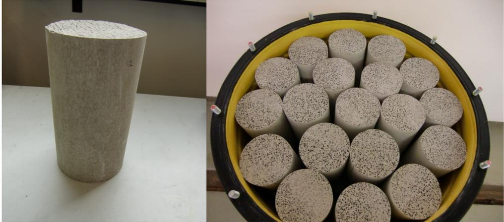
**Abb. 6.3 links:** Betonformkörper mit einem Durchmesser von 110 mm und einer Höhe von 200 mm, **rechts:** Mit Betonformkörpern gefülltes 200-l-Fass mit vier Ebenen zu je 19 Betonformkörpern.
