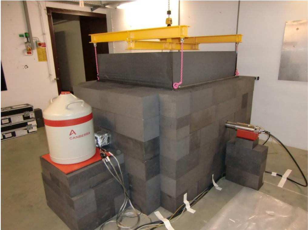
*Abb. 5.2: MEDINA-Testeinrichtung zur stofflichen Charakterisierung von 200-l-Fässern.*
