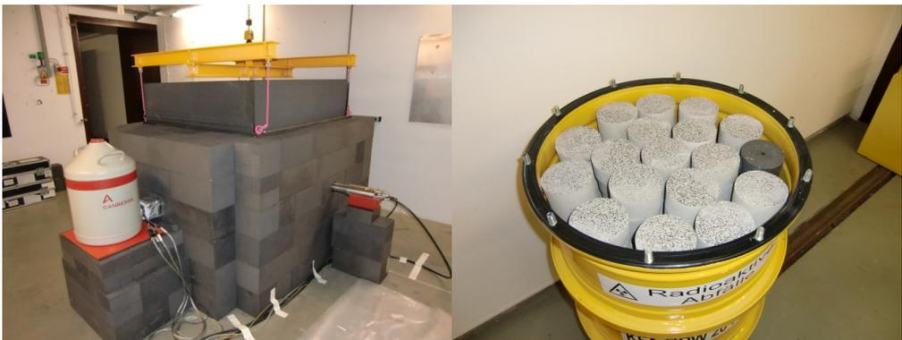
**Abb. 1.1** links: MEDINA-Testeinrichtung zur Untersuchung von 200-l-Fässern, rechts: 200-l-Probenfass befüllt mit Betonformkörpern und einer Bleiprobe für Inhomogenitätsstudien.
