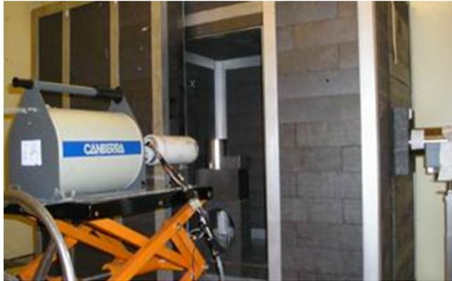
**Abb. 3.12:** Messzelle REGAIN (*Recherche des Gamma d'Activation et d'Irradiation Neutronique*), aufgebaut bei der CEA in Cadarache, Frankreich (Bildquelle: CEA).
