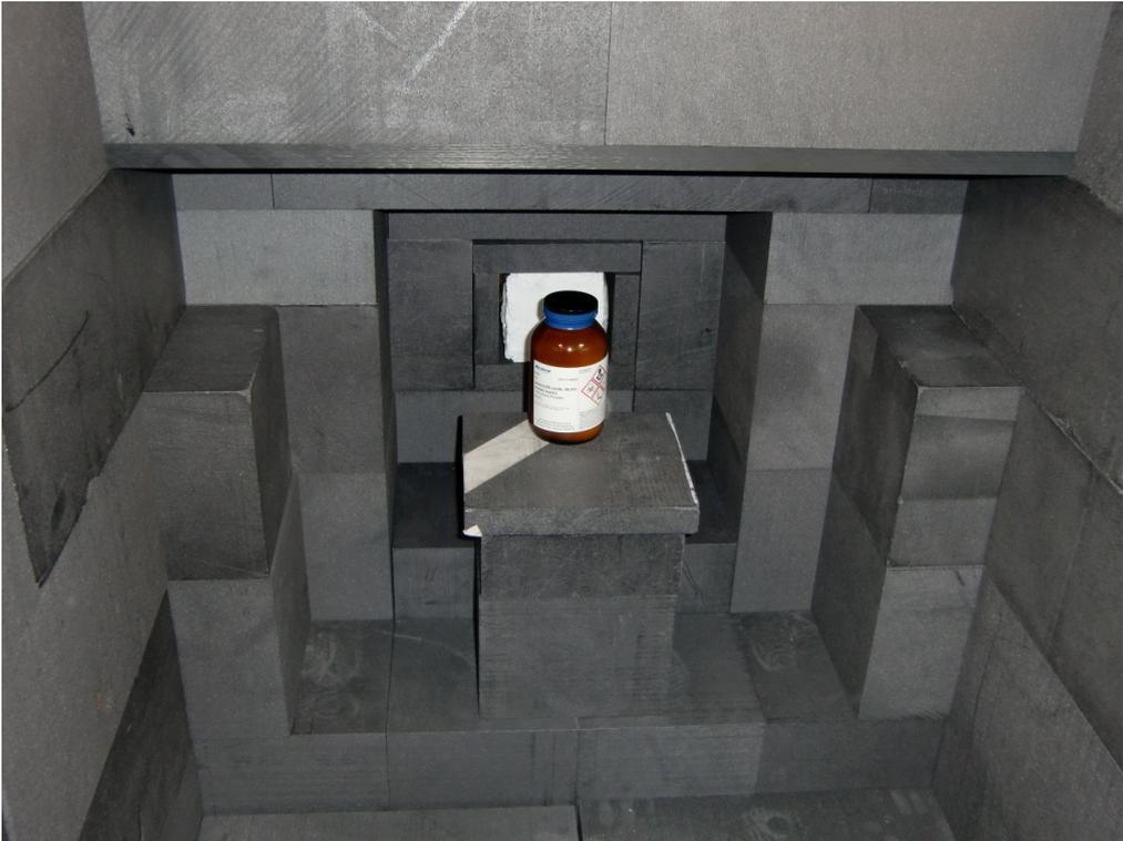
**Abb. 9.5:** Arsenoxidprobe mit einer Nettomasse von 1000 g innerhalb der MEDINA-Bestrahlungskammer zur Aufnahme der charakteristischen Gamma-Signatur.
