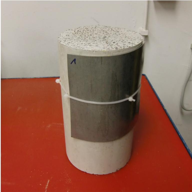
**Abb. 10.1:** Für die Inhomogenitätsstudie verwendete Cadmiumprobe. Das Cadmiumblech mit einer Masse von 134,4 g ist an einen Betonformkörper fixiert.
