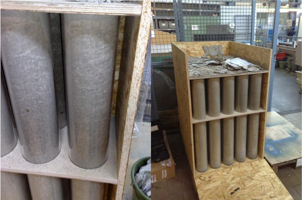
**Abb. 6.1:** Mit Spezialbeton der Firma Franken Maxit GmbH & Co. verfüllte PMMA-Rohre.
