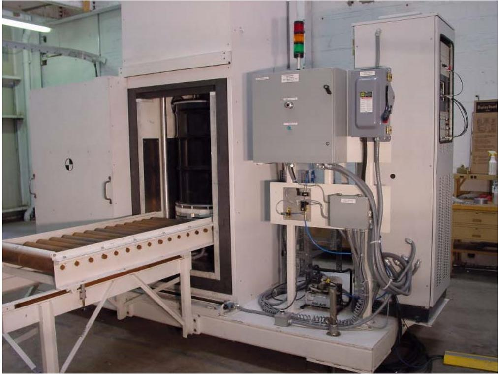
**Abb. 3.11:** PGNAA Prototypensystem der Firma Westinghouse zur Prüfung von 208-Liter-Fässern aus dem Jahr 2000. Die Tür der Bestrahlungskammer ist offen, um die Position des Fasses in der Kammer zu zeigen. Das Fass kann während der Messung rotiert und angehoben werden /3-26/.
