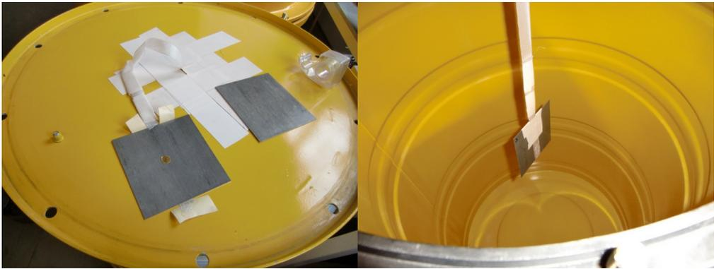
**Abb. 8.1:** Experiment zur Bestimmung des Neutronenflusses im Mittelpunkt eines 200-l-RRW-Fasses. Die Goldfolie wird zur Bestimmung des epithermischen Neutronenflusses zwischen zwei Cadmiumblechen bestrahlt.
