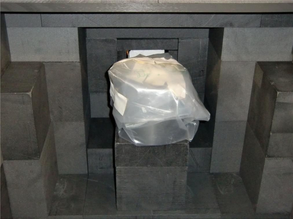
**Abb. 9.4:** *Berylliumprobe innerhalb der MEDINA-Bestrahlungskammer zur Aufnahme der charakteristischen Gamma-Signatur.*
