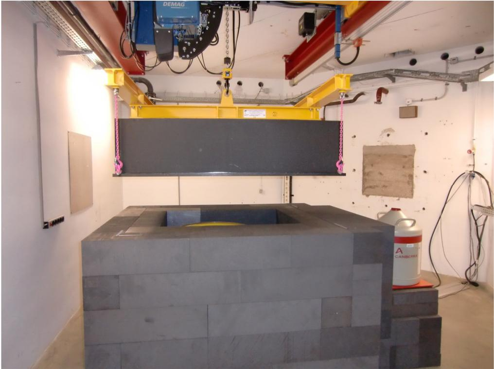
**Abb. 5.9:** Abgenommene Deckenkonstruktion der MEDINA-Testeinrichtung für den Wechsel eines Probenfasses.
