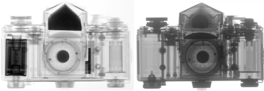
**Abb. 2.8:** Vergleich zweier Radiographien, Neutronenradiographie (links) und Gammadiographie (rechts) /2-21/.
