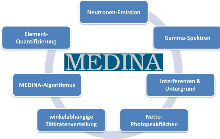
**Abb. 11.1:** Verfahrensablauf der Elementquantifizierung mittels des MEDINA-Analyseverfahrens.
