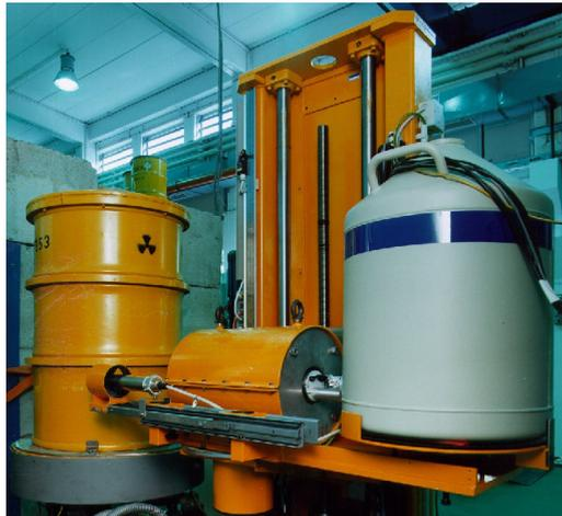
**Abb. 2.16:** Gamma-Scanner GERNOD II zur Routineuntersuchung radioaktiver Abfallfässer. (Bildquelle: Forschungszentrum Jülich)
