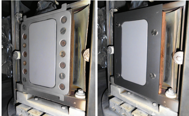
Abbildung 4.10.: Am Substrathalter der Entwicklungsanlage gespannte MSC-Proben im Kassettendesign; unmaskiert (links); maskiert (rechts); Versuche durchgeführt am Fraunhofer IST
