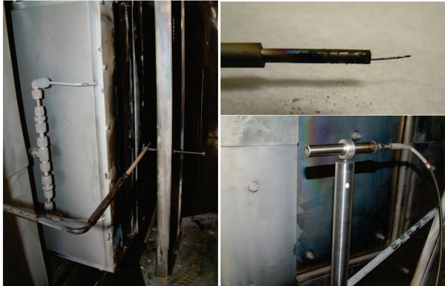
Abbildung 4.14.: Plasmadiagnostische Untersuchungen; Langmuirsondenmessung (links); Langmuir-Sonde nach erfolgter Messung (rechts oben); OES-Messung (rechts unten); Versuche durchgeführt bei PhysTech
