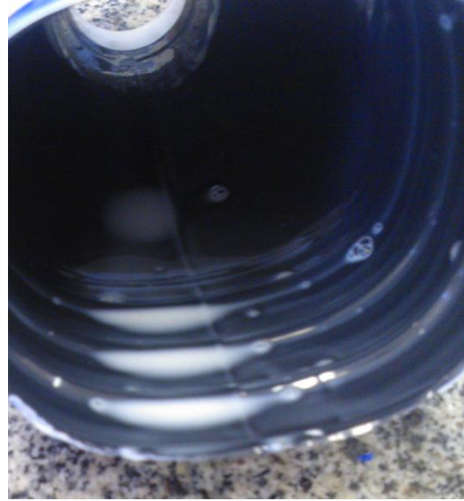
Figura 29 - Ondulações presentes na parte interna da embalagem (Grupo 9). Fonte: o autor.
