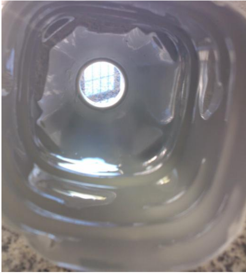
Figura 28 - Ondulações presentes na parte interna da embalagem (Grupo 8). Fonte: o autor.
