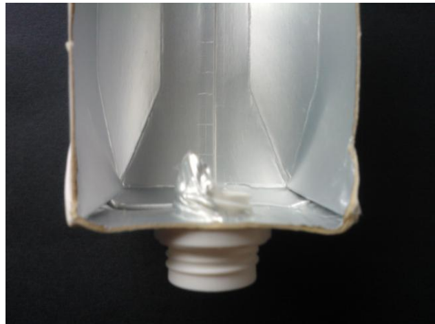
Figura 21 - Abertura da embalagem vista internamente e de frente (Grupo 4). Fonte: o autor.
