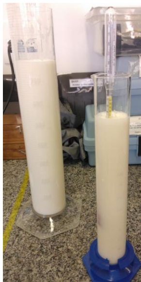
Figura 16 - Determinação da densidade lida do leite e sua temperatura. Fonte: o autor.
