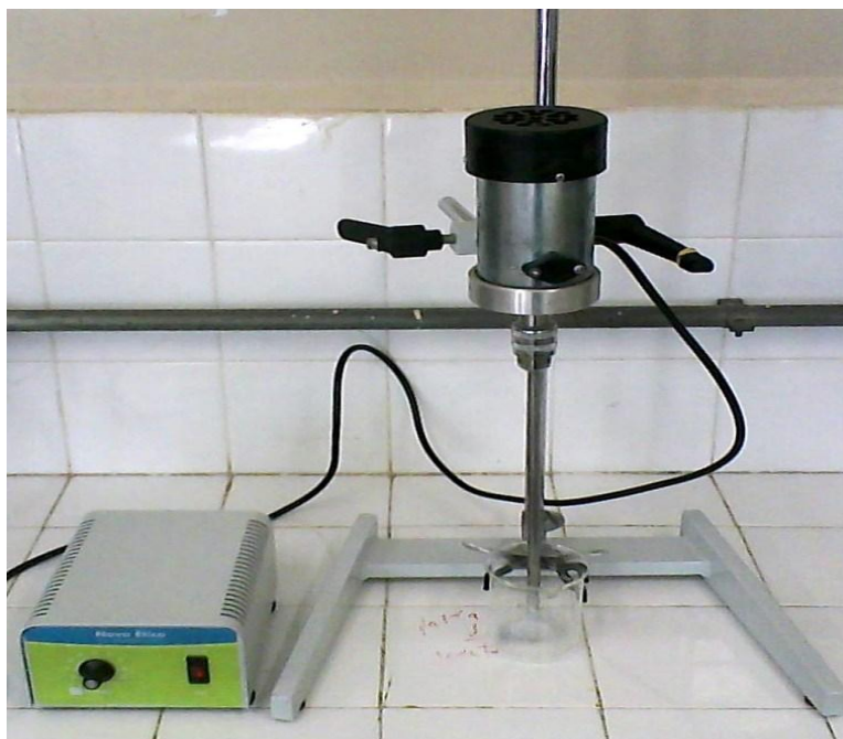
Figura 3.6: Foto ilustrativa do agitador mecânico utilizado no experimento de liberação controlada de vitamina C incorporada ao coacervato de cálcio ( PCa = 2 ).
