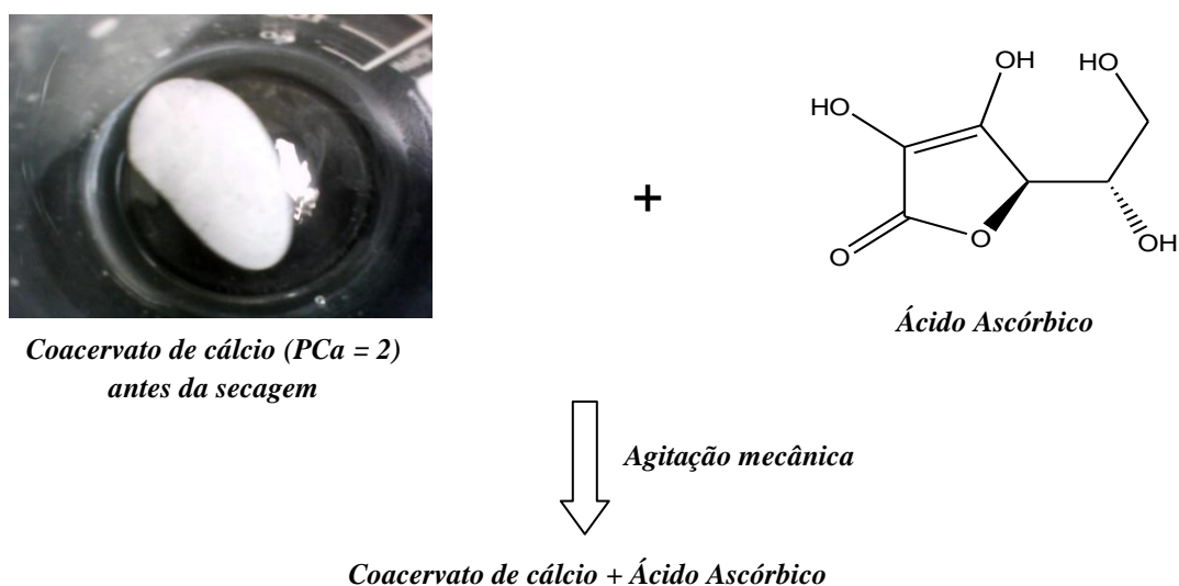
Figura 3.5: Esquema de incorporação e preparação do coacervato de cálcio (PCa = 2) com Ácido Ascórbico.
