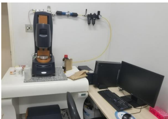
Figura 6 - Reômetro Dinâmico Oscilatório DHR1 da T.A Instruments.
