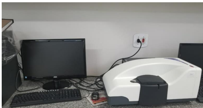
Figura 5 - Zetasizer Nanoseries Malvern utilizado para obtenção do Diâmetro Hidrodinâmico ( D_h ) e Potencial Zeta (PZ).
