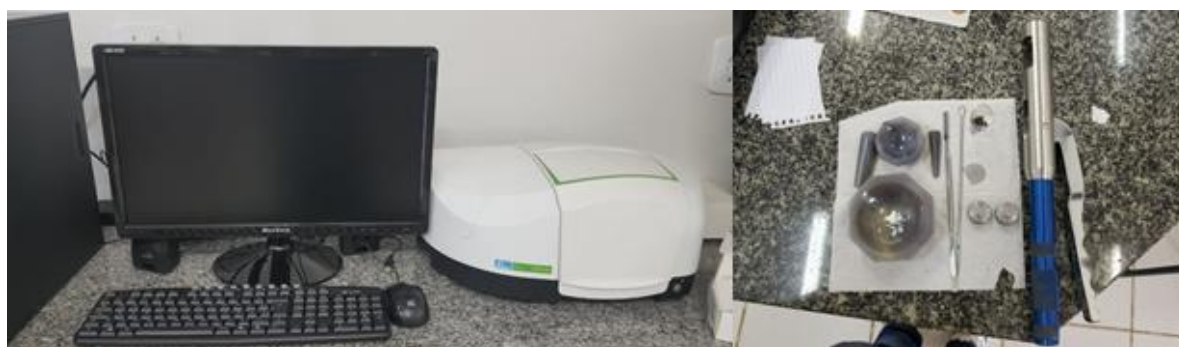
Figura 3 - Espectrofotômetro Perkin-Elmer utilizado para obtenção dos espectros de infravermelho
