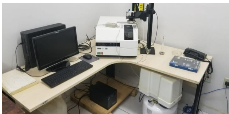
Figura 4 - Analisador termogravimétrico simultâneo TGA/DTA utilizado na avaliação do perfil térmico das amostras
