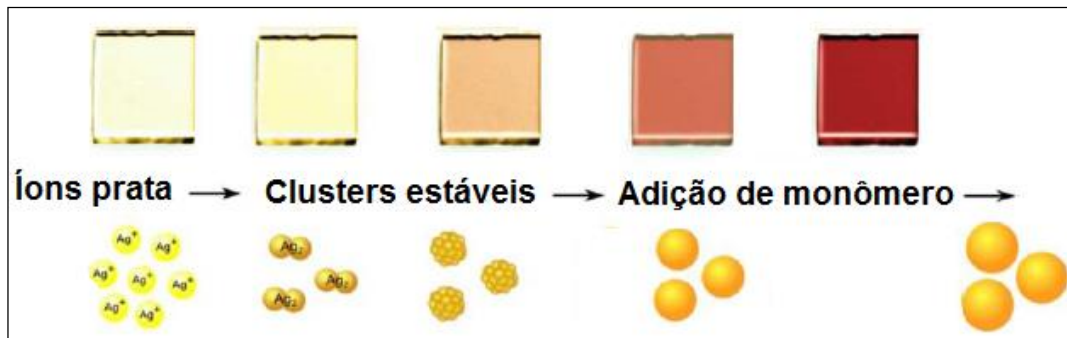
Figura 7: Etapas dos mecanismos de crescimento das nanopartículas metálicas de \text{Ag}^0 em vidros de silicato via tratamento térmico.
