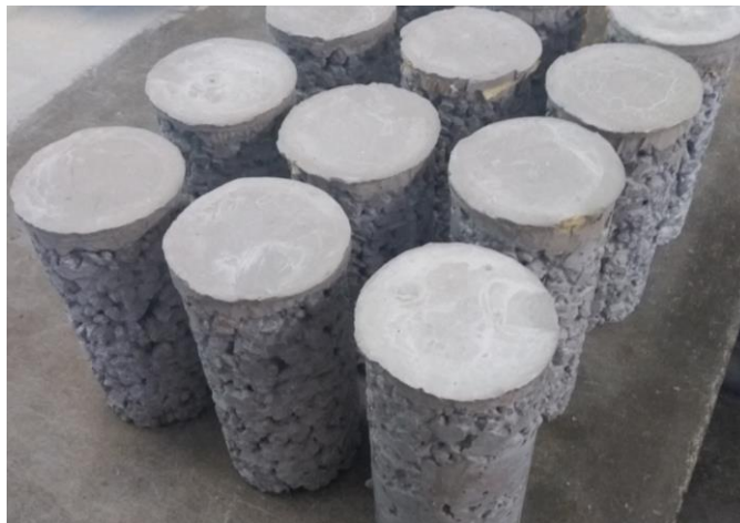
Figura 36 – Corpos de prova cilíndricos capeados. (Fonte: Autor, 2018)
