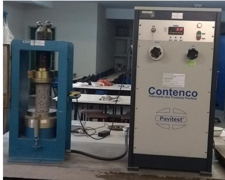
Figura 37 – Prensa eletro-hidráulica utilizada nos ensaios mecânicos. (Fonte: Autor, 2018)
