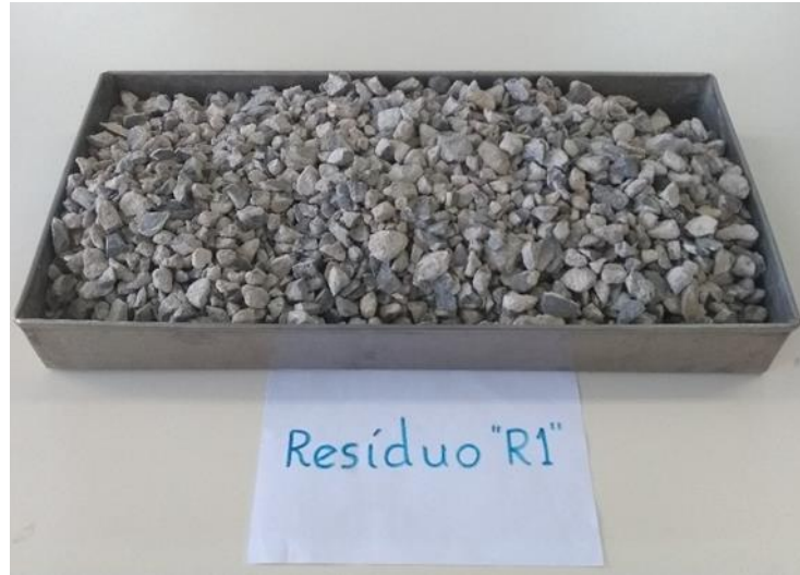
Figura 20 – Resíduo de concreto triturado. (Fonte: Autor, 2018)
