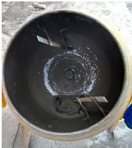
Figura 25 – Lubrificação da betoneira. (Fonte: Autor, 2018).
