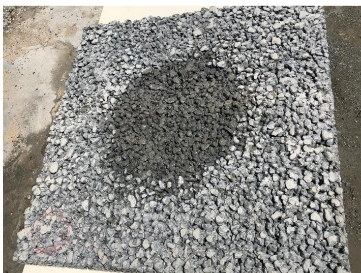
Figura 45 – Placa de concreto permeável após ensaio de determinação de coeficiente de permeabilidade. (Fonte: Autor, 2018)
