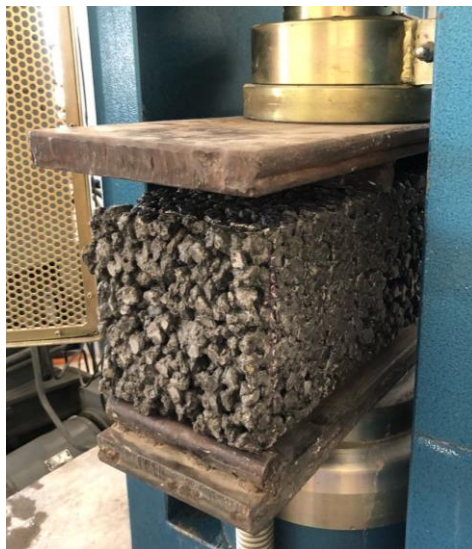
Figura 39 – Ensaio de resistência à tração na flexão. (Fonte: Autor, 2018)
