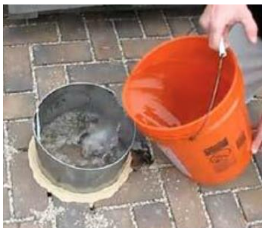
Figura 9 – Coeficiente de permeabilidade por anel de infiltração. (Fonte: Marchioni e Silva, 2011)
