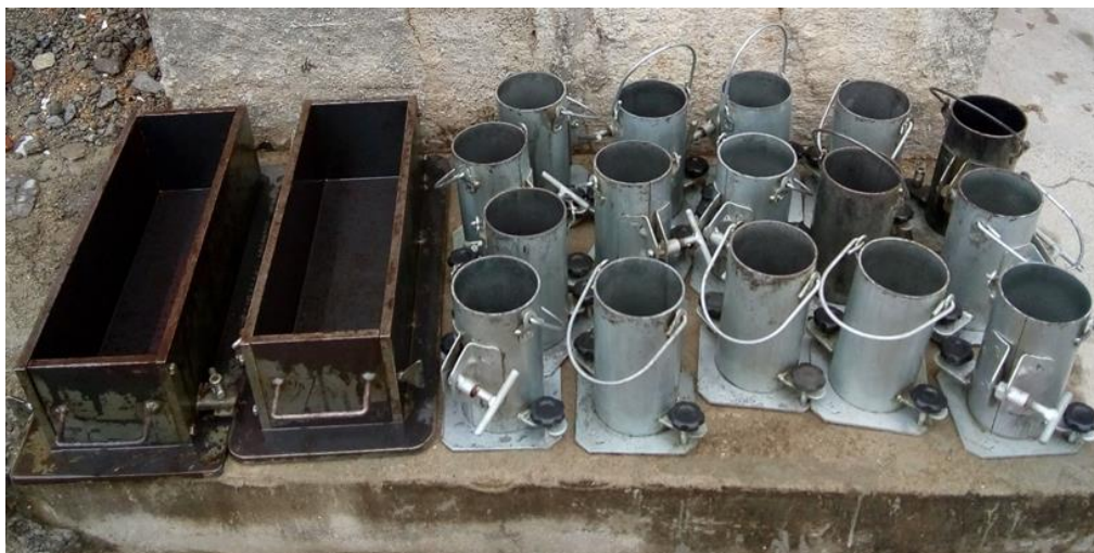
Figura 28 – Moldes para moldagem dos corpos de prova cilíndricos e prismáticos. (Fonte: Autor, 2018)
