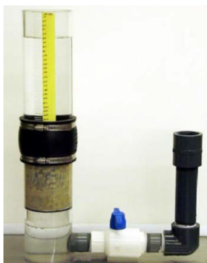
Figura 10 – Mecanismo elaborado para medição do coeficiente de permeabilidade em concretos permeáveis. (Fonte: Olek et al. , 2003)
