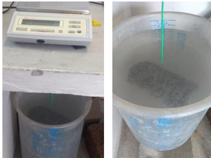
Figura 35 – Determinação da massa submersa das amostras. (Fonte: Autor, 2018)
