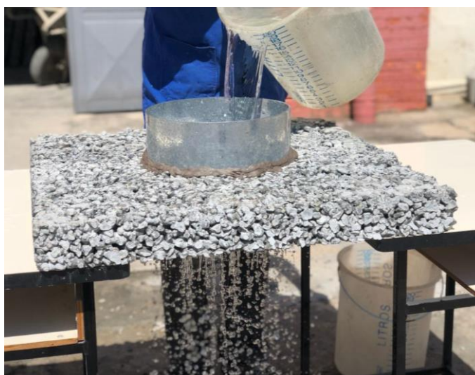
Figura 44 – Ensaio de determinação do coeficiente de permeabilidade. (Fonte: Autor, 2018)
