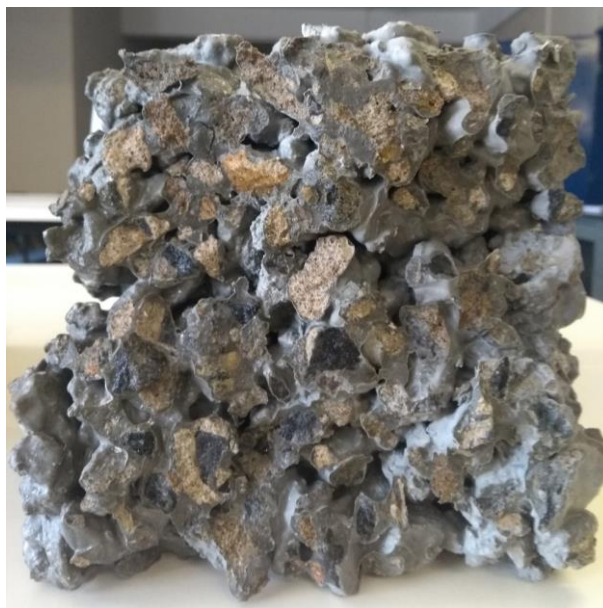
Figura 54 – Corpo de prova prismático de concreto permeável produzido com resíduo de concreto após o rompimento. (Fonte: Autor, 2018)
