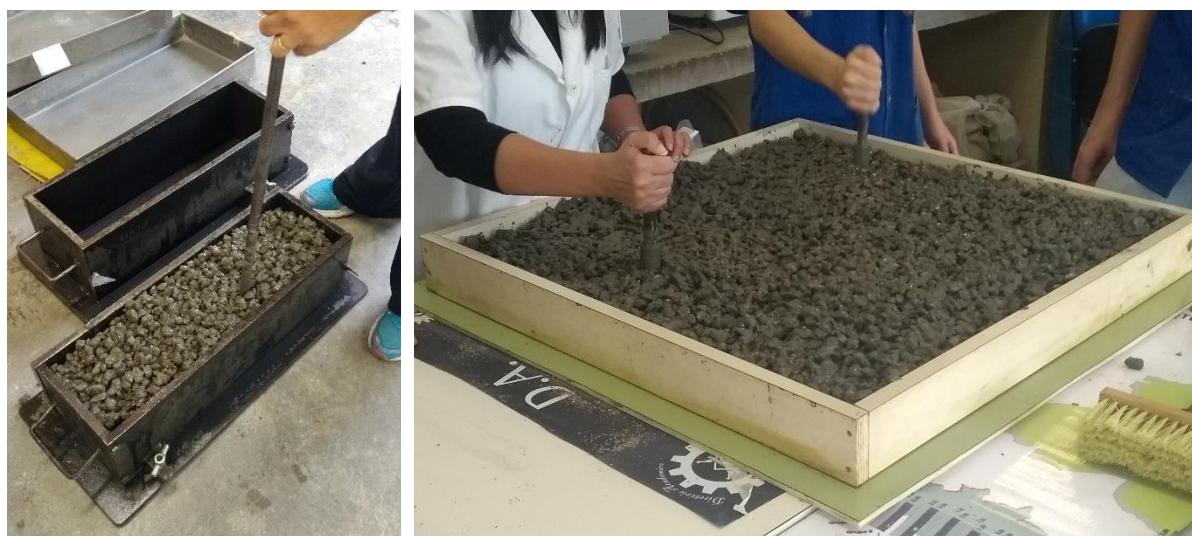
Figura 30 – Moldagem de prisma e placa de concreto permeável. (Fonte: Autor, 2018)
