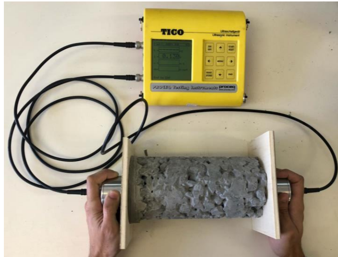
Figura 42 – Determinação da velocidade de propagação de onda ultrassônica. (Fonte: Autor, 2018)
