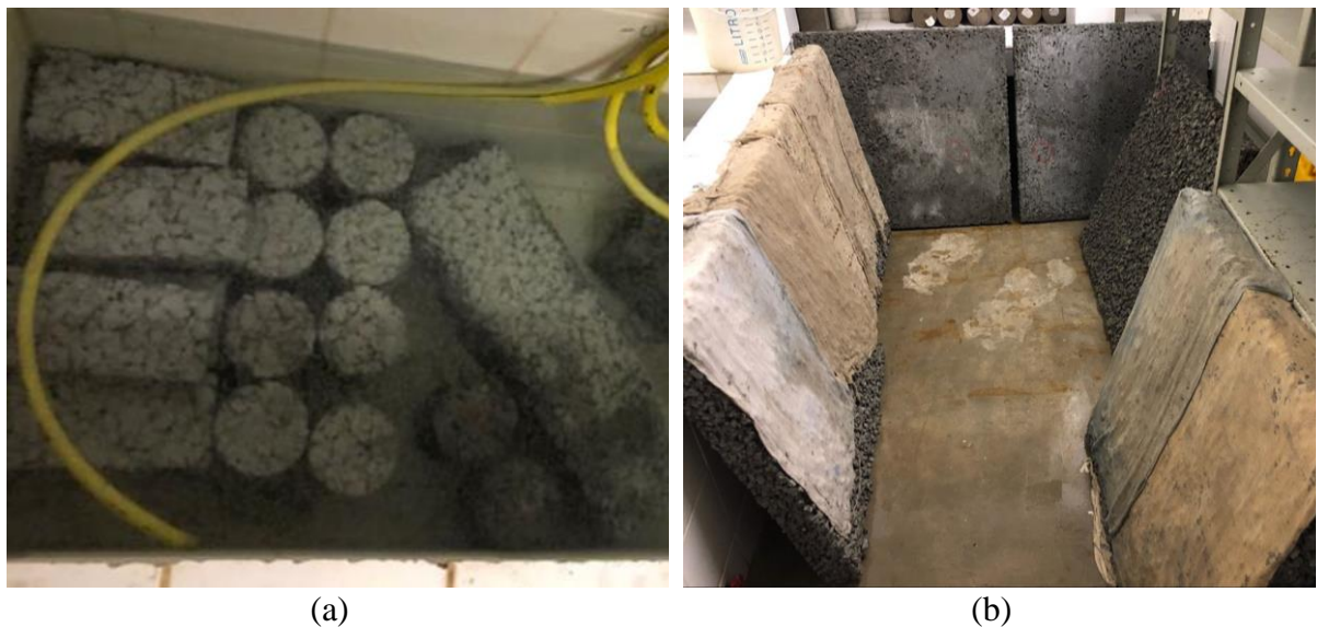
Figura 32 – Cura das amostras em câmara úmida: (a) peças, CPs cilíndricos e prismáticos em tanque d'água; (b) placas cobertas por panos úmidos em câmara úmida. (Fonte: Autor, 2018)
