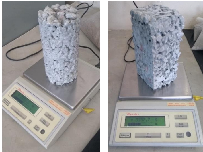
Figura 34 – Determinação da massa seca das amostras. (Fonte: Autor, 2018)
