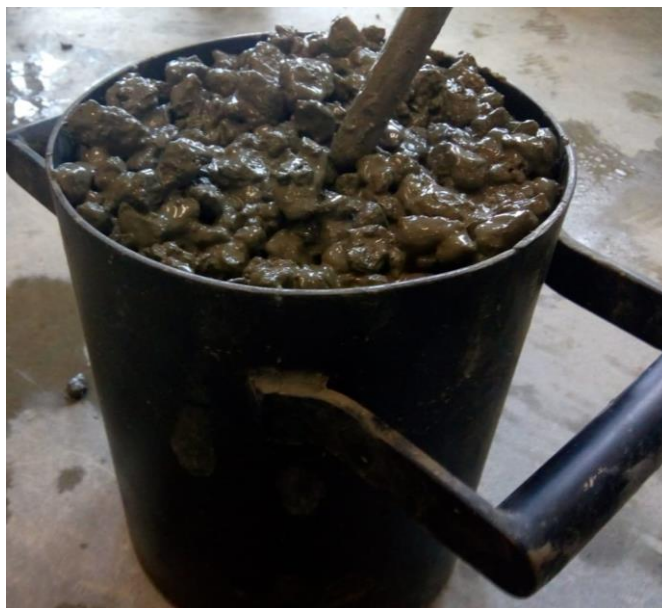
Figura 33 – Ensaio de determinação da massa específica do concreto permeável no estado fresco.
