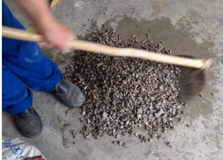
Figura 24 – Pré-umidificação do agregado reciclado. (Fonte: Autor, 2018)
