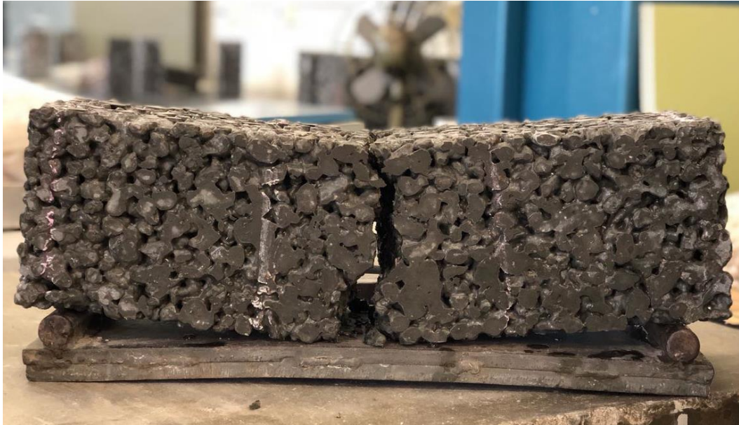
Figura 40 – Condição de corpo de prova prismático submetido ao ensaio de resistência à tração na flexão após o rompimento. (Fonte: Autor, 2018)
