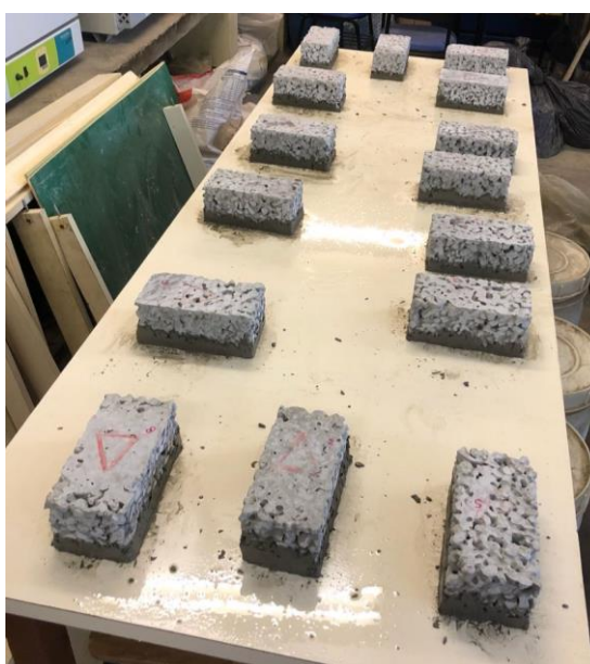
Figura 41 – Capeamento das peças de concreto permeável para pavimentação intertravada. (Fonte: Autor, 2018)
