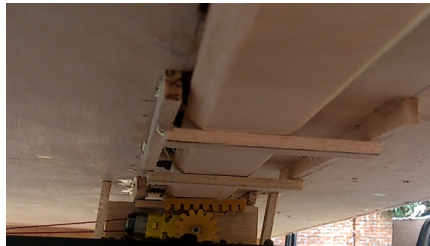
Gambar 15. Mekanisme pembuka tutup otomatis
