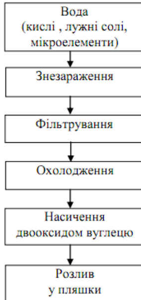
Рис. 9.1. Технологічна схема виробництва мінеральної води, що добувається з надр землі
