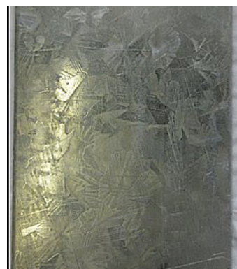
Gambar 2. Foto makro sampel uji baja galvanis sebelum ekspos di Pelabuhan Ratu
