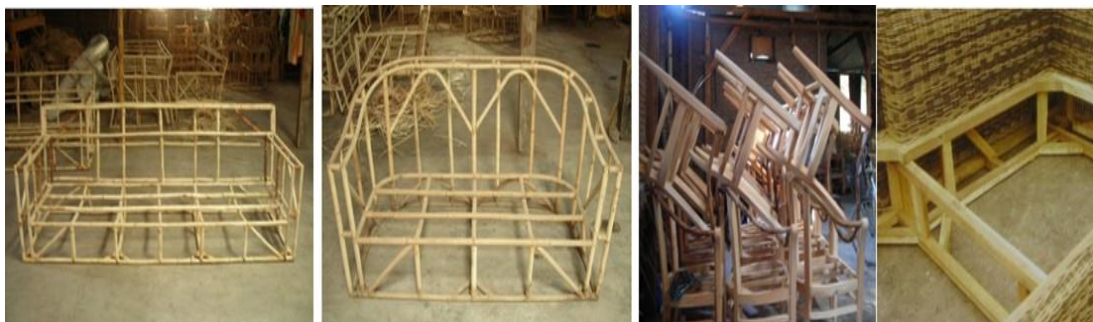
Gambar 10. Rangka sofa dari batang rotan dan bahan kayu) Sumber : dokumen pribadi
