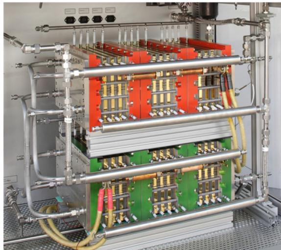
Abbildung 69: Wesentliche Auslegungsdaten für die zwei Fullstacks, fertiger Aufbau mit Verrohrung und Lastanschlusskabeln (ohne Isolierungen)
