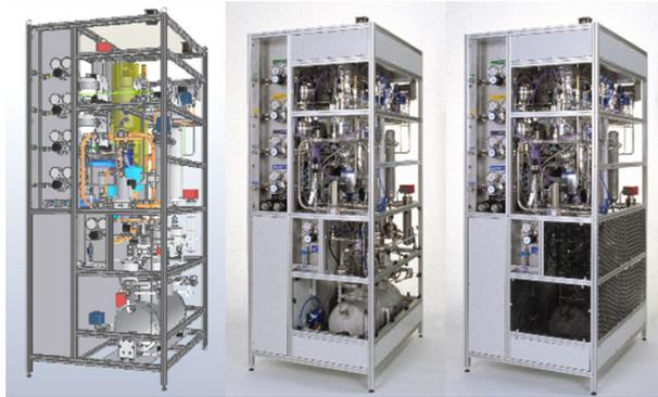
Abbildung 8: Plug & Play“-Modul mit Reformer vom Typ 5
