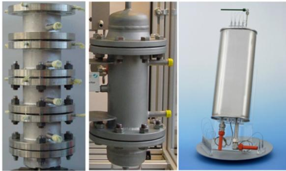
Abbildung 6: Wasser-Gas-Shift Reactoren der Typen WGS 1, WGS 2 und WGS 3
