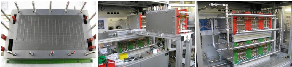
Abbildung 68: links: Modulassembly (12 Zellen, 320 cm<sup>2</sup> aktive Zellfläche), Mitte: Moduleinbau in Teststand, rechts: assemblierte Fullstacks mit ersten Anschlüssen
