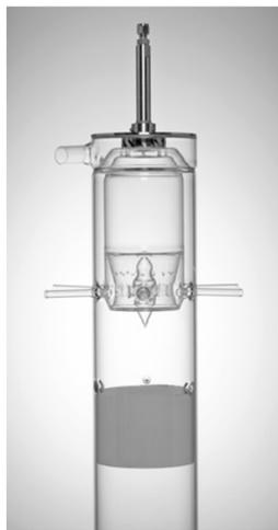
Abbildung 5: Quarzglasmodell des ATR 10 zur Strömungsvisualisierung
