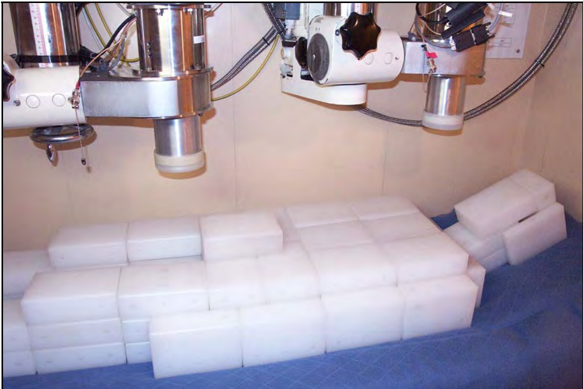
Abbildung 2.4: Blick in den Ganzkörperzähler mit Blockziegelphantom
