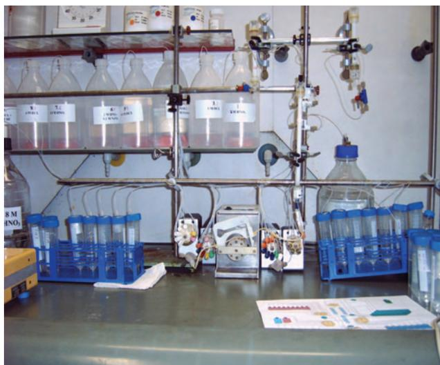
Abbildung 3-3: Der Vorläufer der Anlage zur automatischen Trennung von Nukliden
