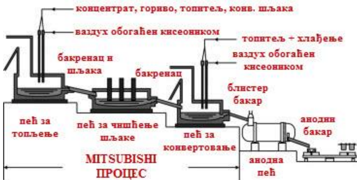
Слика 6.4. Mitsubishi поступак континуираног топљења бакарних концентрата (Schlesinger et al., 2011; Najdenov, 2013).
