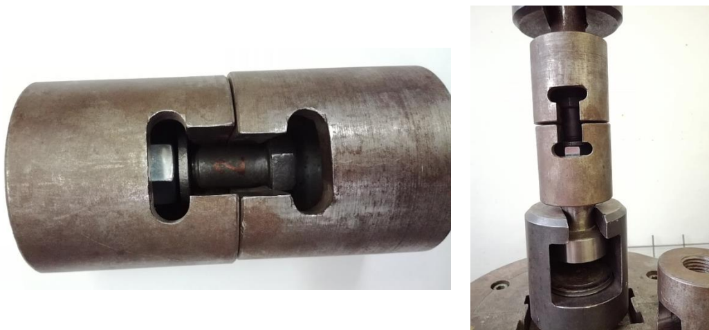
Слика 4-2: Испитивање завртња на затезање - носивост завртња
