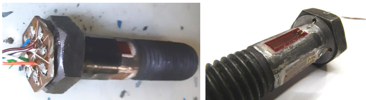
Слика 4-13: Завртањ са четири линеарне мерне траке по свом обиму
