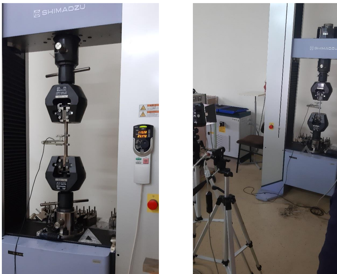
Слика 4-37: Испитивање својстава материјала на тест машини Shimadzu
