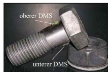
Слика 2-31: Поставка и начин мерења силе у завртњима у раду [182]
