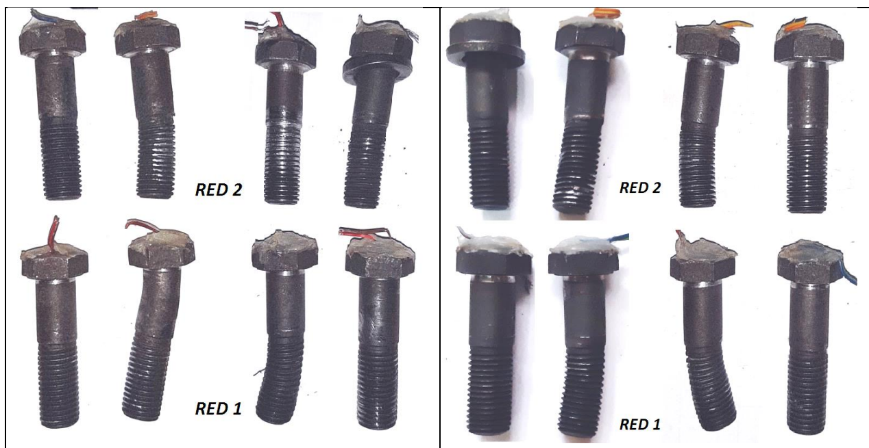
Слика 5-53: Завртњеви након теста – веза P1 (лево) и веза P2 (десно) према распореду у чеаној плочи
