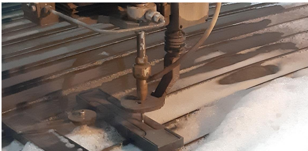
Слика : Сечење епрувете EP2-1 воденим млазом
