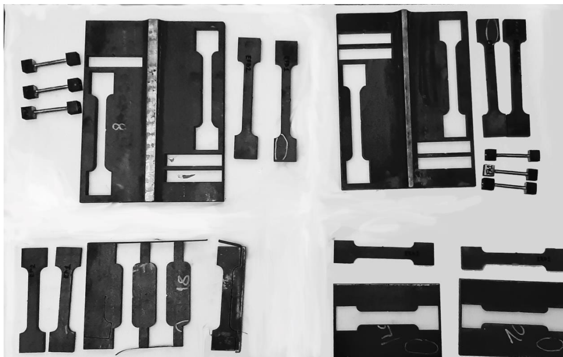
Слика 4-32: Слика епрувета прве фазе са плочама из које су исечене млазом воденог притиска
