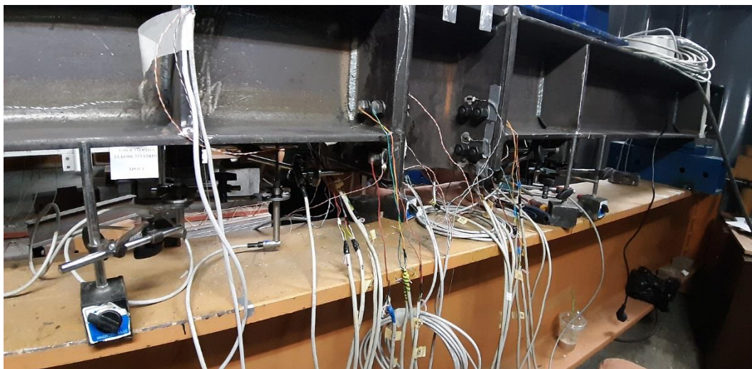
Слика 4-45: Мерење померања и дилатација у тесту Р
