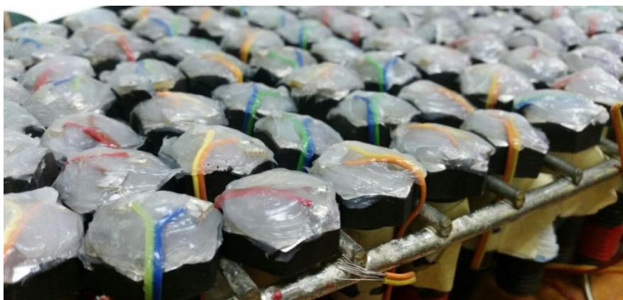
Слика 4-11: Заштита електро спојева силиконом
