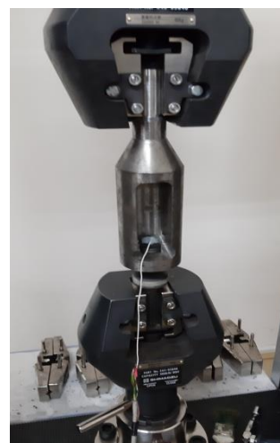
Слика 4-15: Дијаграм промене силе по времену током калибрације завртњева (лево) и слика једног завртња током калибрације (десно)
