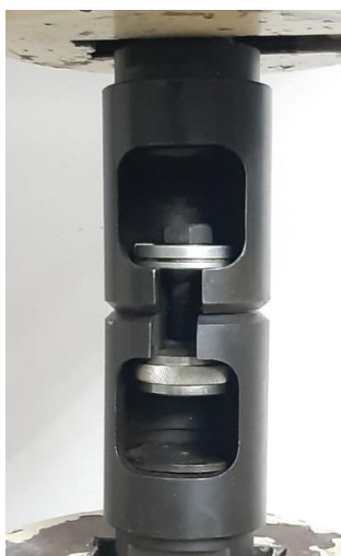
Слика 4-4: Испитивање носивости и дуктилности завртњева
