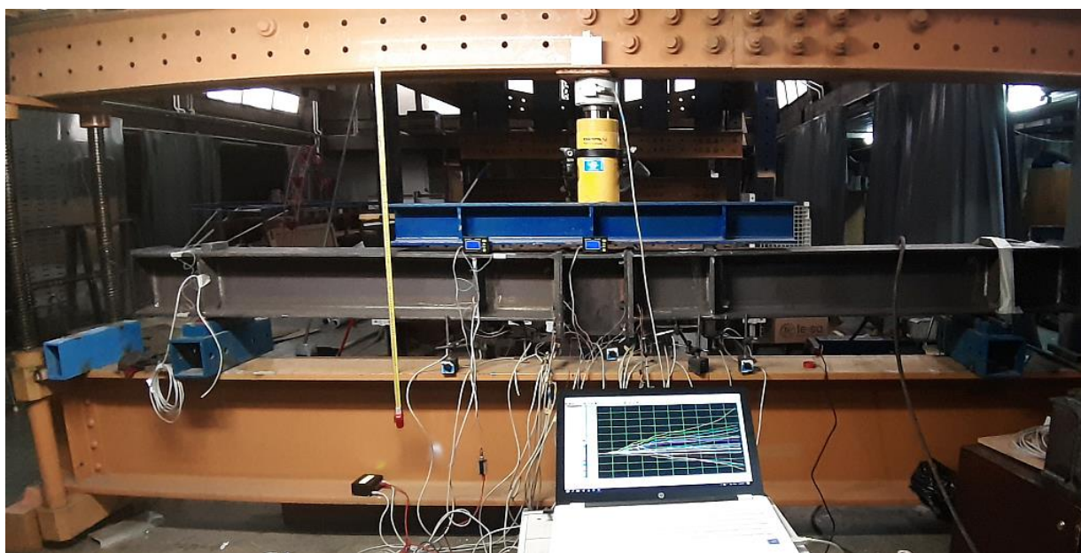
Слика 4-42: Поставка теста P – две греде везане за централни стуб везама са чеоним плочама са препустом и са четири завртња у реду
