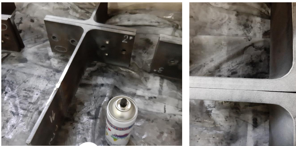
Слика 4-26: Фаза припреме узорка - наношење шаблона спрејем црне боје
