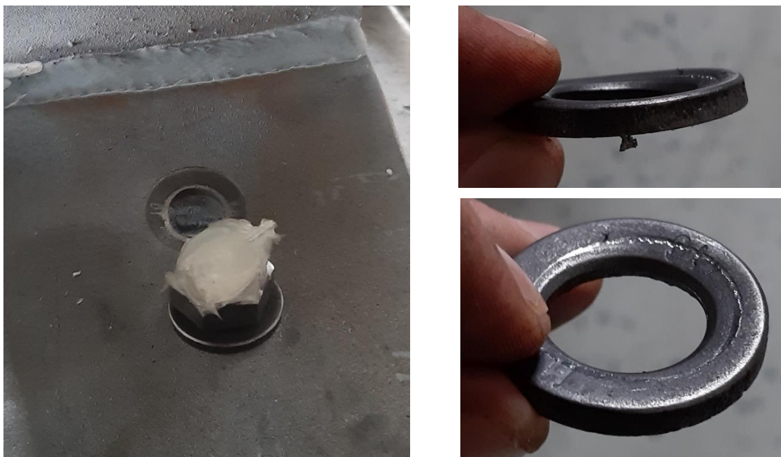
Слика 5-10: Узорак Т1-10-2А након лома завртња – утискивање подлошке у плочу
