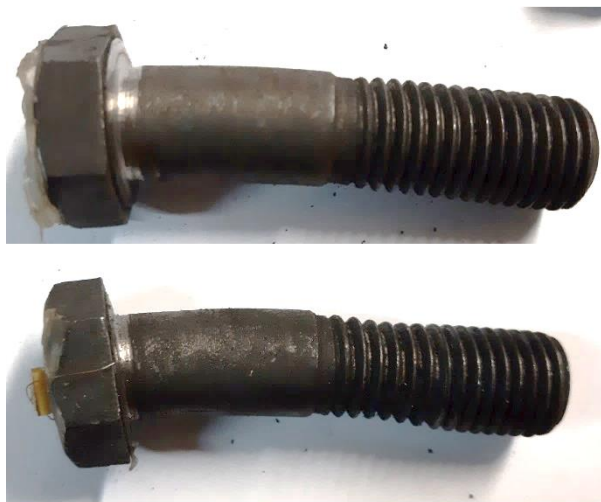
Слика 5-64: Унутрашњи затегнути завртњеви везе F1 (лево) и поломљени завртња везе F2 (десно)
