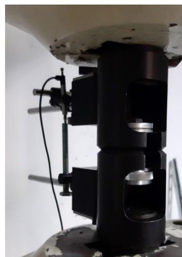
Слика 4-4: Испитивање носивости и дуктилности завртњева
