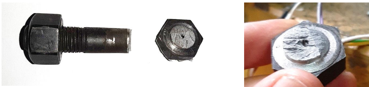
Слика 5-63: Завртња у ком је дошло до лома у тесту F
