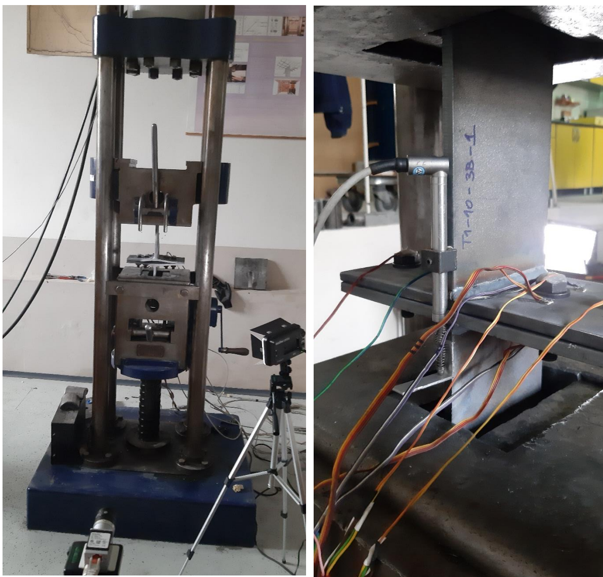
Слика 4-40: Поставка прве фазе експеримента – камера, кидалица, осветљење (лево) и два узорка постављена за тест, са LVDT-ом, са задње стране (десно)
