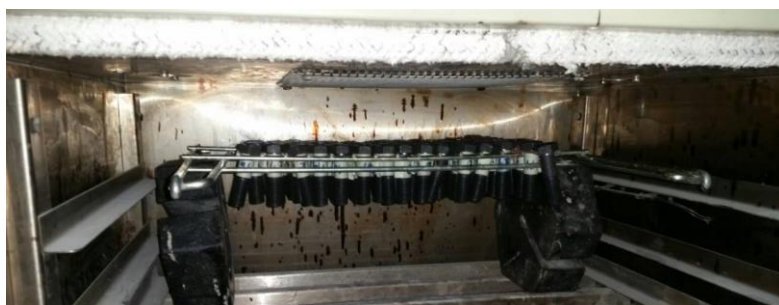
Слика 4-8: Термички третман атхезива у лабораторијској сушници
