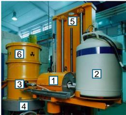
Abb. 1: Das Gamma-Scan-System Gernod 2 im Forschungszentrum Jülich.
