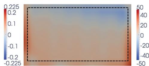
Abbildung 7.10: Differenzbild der lokalen Stromdichteverteilung für den Betriebspunkt  $i = 0.45 \text{ A cm}^{-2}$ ; (linke Skala: absolut in A cm<sup>-2</sup>; rechte Skala: relativ in %)
