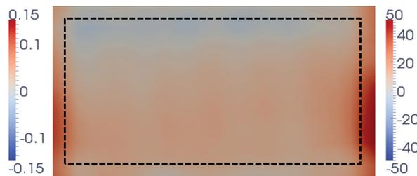
Abbildung 7.21: Differenzbild der lokalen Stromdichteverteilung für den Betriebspunkt  $i = 0.30 \text{ A cm}^{-2}$ ; (linke Skala: absolut in A cm<sup>-2</sup>; rechte Skala: relativ in %)
