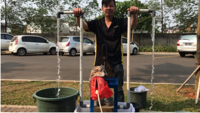
Gambar 5. Pengujian Debit Air Pompa Torak Sebagai Pengumpan Pompa Hidram
