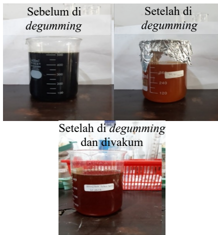
Gambar 1. Perubahan warna dari minyak biji nyamplung sebelum dan sesudah dilakukan proses degumming
