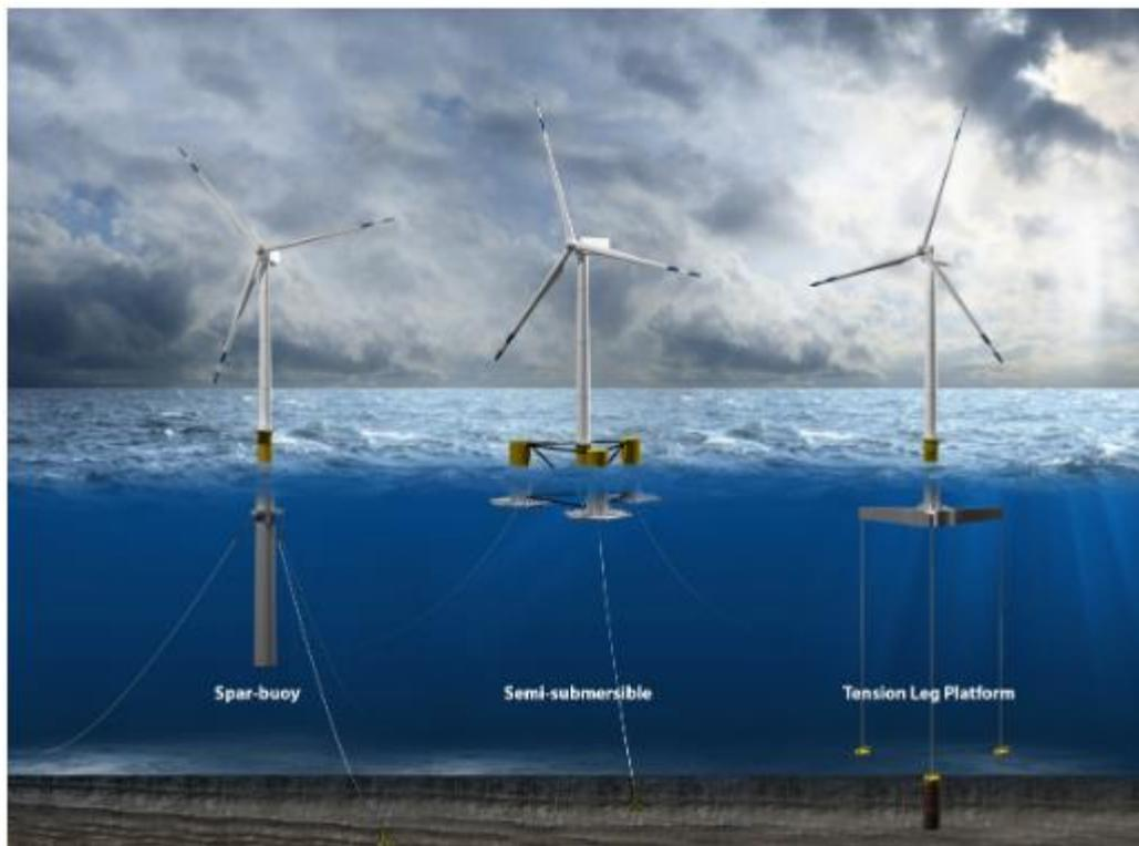
**Figura 1-3 – Tipos de Estruturas Flutuantes para geração de Energia eólica offshore [7]**
