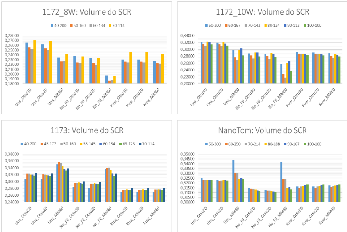
Figura 27. Valores de volume do SCR referentes as diferentes relações kV/\mu A em cores distribuídos entre os tipos de filtros e algoritmos de segmentação utilizados.
