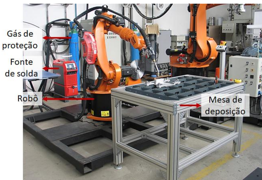
Figura 3-1 – Sistema de deposição WAAM controlado robô de 6 eixos de liberdade, fonte de solda Fronius TPS 400i, gás de proteção e mesa de deposição.
