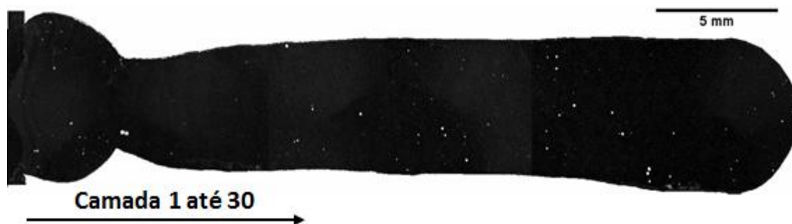
Figura 4-6 – Macrografia obtida da caixa com 30 camadas depositadas pelo processo CMT Pulse. Os pontos redondos e claros são porosidades.
