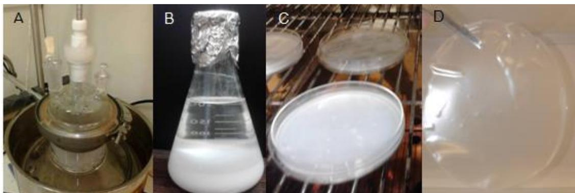
**Figura 5.** Etapas de fabricação dos filmes: A) Gelatinização do amido; B) Sedimentação do precipitado C) Secagem das placas; D) Filme pronto.
