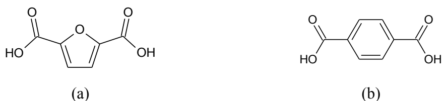
Figura 5. Comparação entre as estruturas químicas do (a) ácido 2,5-furanodicarboxílico e do (b) ácido tereftálico.
