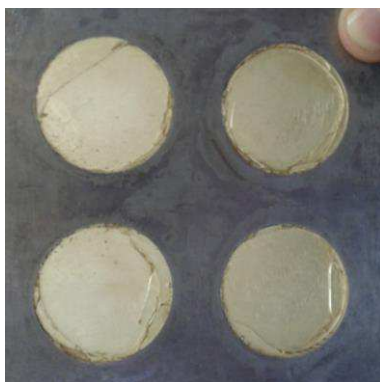
Figura 31. Corpos de prova sintetizados por compressão a 200 °C e 6 ton, utilizando os copolímeros furânicos.
