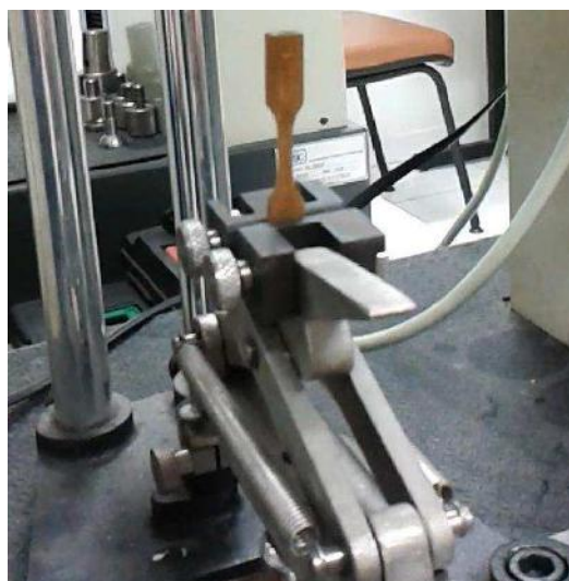
Figura 50. Corpo de prova de poli(2,5-furanodicarboxilato de etileno) modificado com ácido succínico e glicerol fixado à garra da máquina universal de ensaios.
