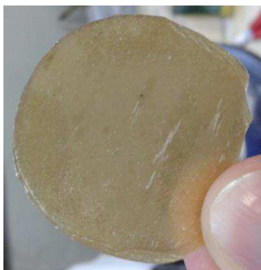
Figura 32. Corpo de prova conformado por compressão a 200 °C e 6 ton, utilizando os copolímeros furânicos a ser analisado no reômetro.
