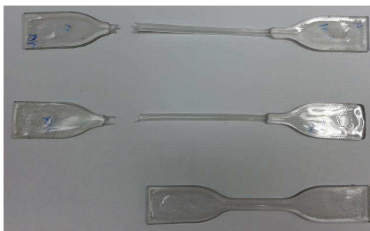
Figura 23. Exemplos de corpos de prova de poli(tereftalato de etileno) antes e após ensaios de tração.
