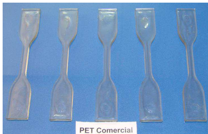
Figura 22. Corpos de prova Tipo IV sintetizados com poli(tereftalato de etileno) nas condições reunidas na Tabela 5.
