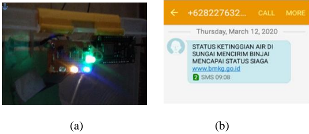
Gambar 9. (a) LED Menyala Orange, (b) SMS Gateway yang terkirim Level Siaga
