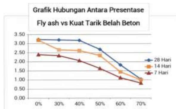
Gambar 5. Grafik hubungan antara presentase fly ash vs kuat tarik belah beton
