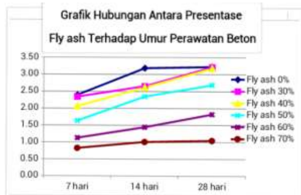
Gambar 4. Grafik hubungan antara presentase fly ash terhadap umur perawatan beton
