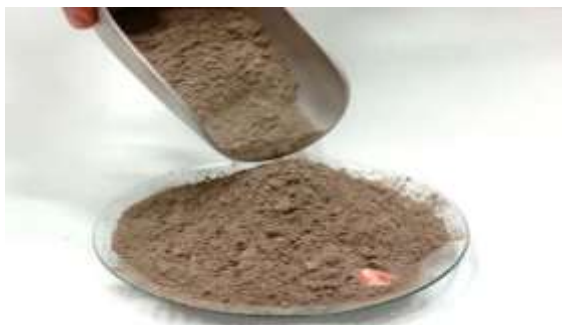
Gambar 2. Bentuk fisik fly ash (Sumber : Hasil pengujian)
