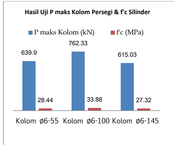
Gambar 7. Diagram nilai rata-rata  $P_n$  maks kolom berpenampang persegi &  $f'c$  beton.
