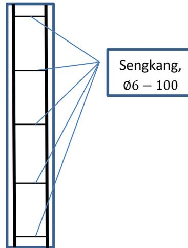
Gambar 5. Kolom dengan jarak sengkang 100 mm.
