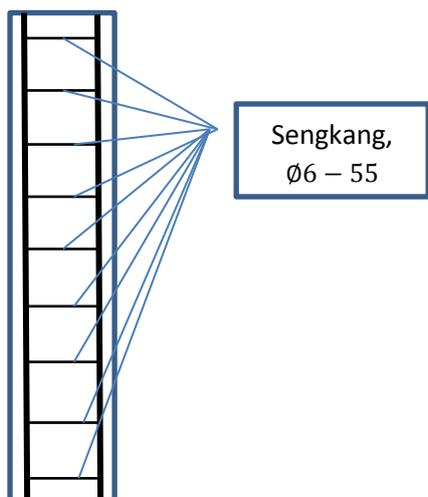
Gambar 4. Kolom dengan jarak sengkang 55 mm.
