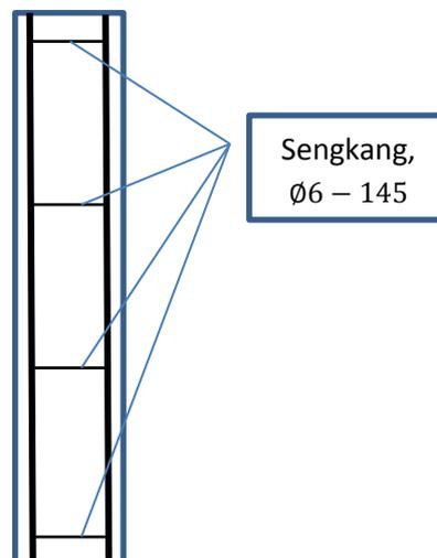
Gambar 6. Kolom dengan jarak sengkang 145 mm.
