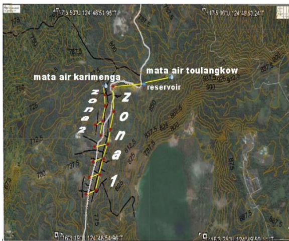
Gambar 3. Skema Perencanaan Sistem Jaringan Perpipaan
