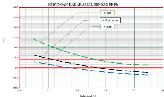
Gambar 8. Hubungan Kadar Aspal dengan Rasio Filler
