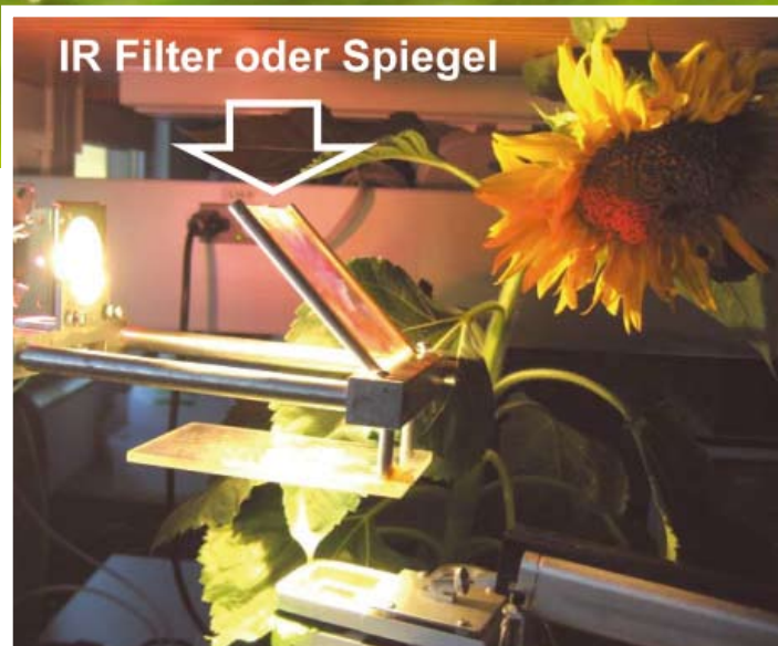
Abb. 1: Ein Sonnenblumenblatt ist eingespannt in einer Blattkuvette und belichtet mit einer Halogenleuchte mit einem IR-Filter.
