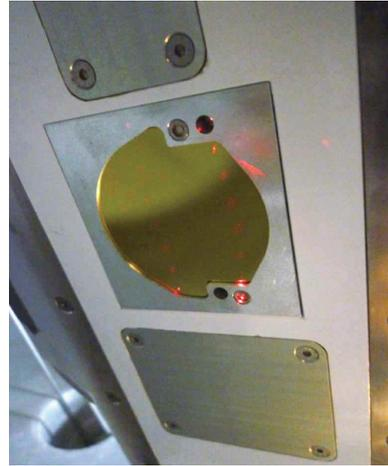
(b) Spiegelhalter mit Detektoren und Faserauskopplungen
