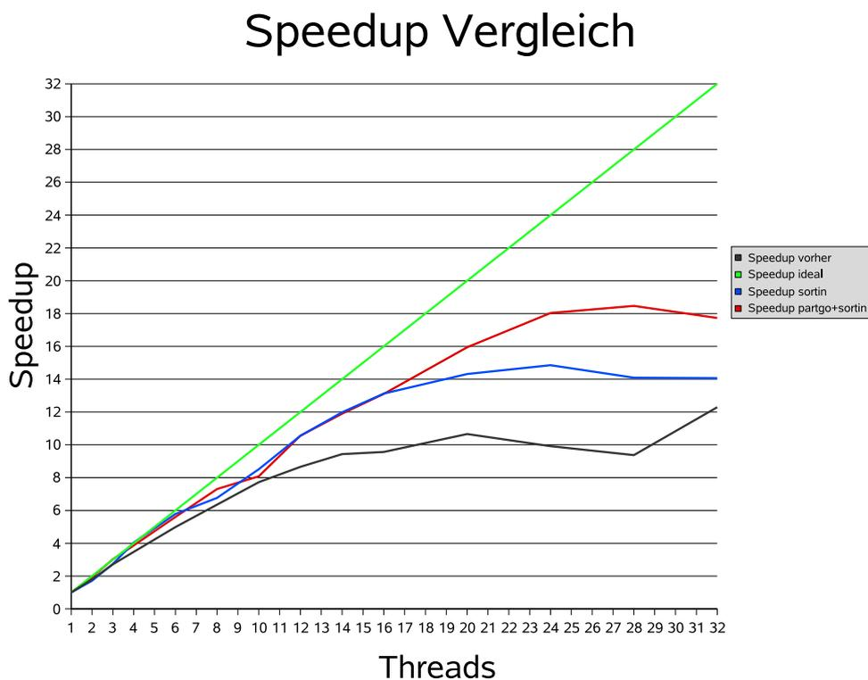
Abbildung 17: Vergleich der verschiedenen Optimierungen mit der Ursprungsversion
