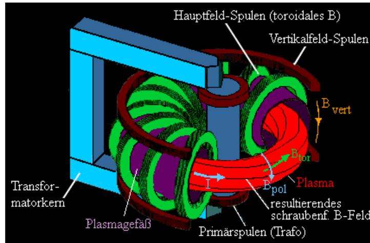
Abbildung 2: Schematik eines Tokamak-Systems
