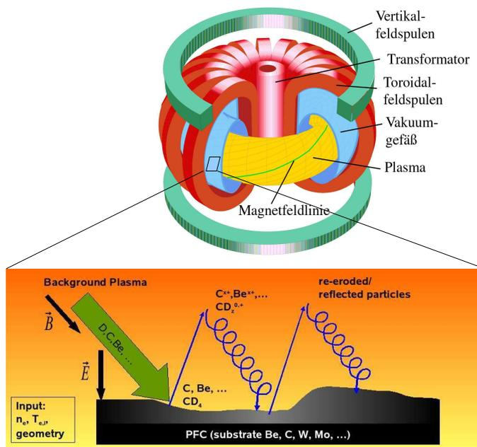
Abbildung 3: Beispielhafte Darstellung der physikalischen Prozesse in ERO.
