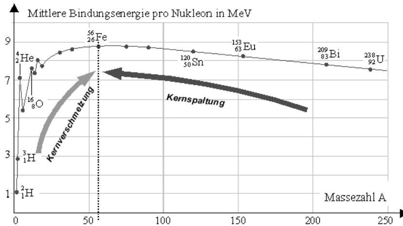
Abbildung 1: Bindungsenergie in Abhängigkeit von der Massenzahl
