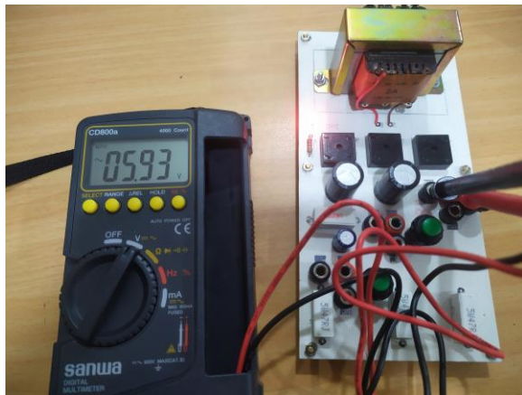
Gambar 3. Pengukuran Tegangan Menggunakan Multimeter
