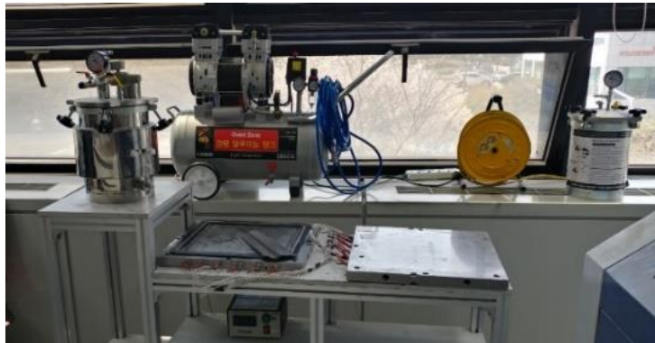
Figure 3.5. Actual RTM setup
