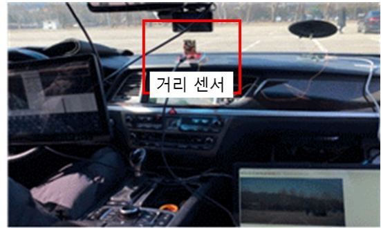
그림 4.1 라이다가 장착된 자율주행차량(좌)과 거리 센서 설치 환경(우)
