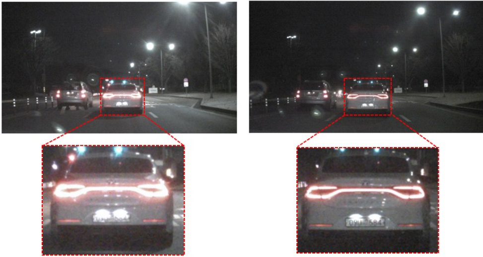
그림 4.7 야간 도로 주행시의 f/1.8 사진(좌)과 f/4.0 사진(우)
