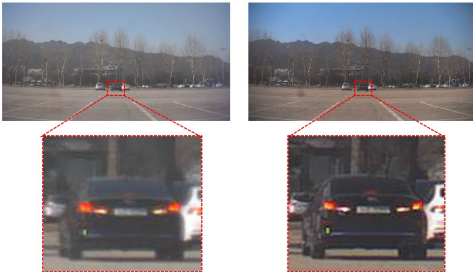
그림 4.6 1차선 차량은 60 m, 2차선 차량은 55 m, 3차선 차량은 70 m 위치에서의 f/1.8 사진(좌)과 f/4.0 사진(우)
