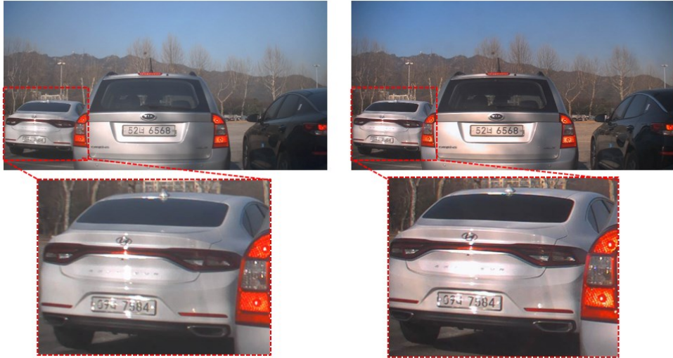
그림 4.4 1차선 차량은 9 m, 2차선 차량은 4 m, 3차선 차량은 3 m 위치에서의 f/1.8 사진(좌)과 f/4.0 사진(우)
