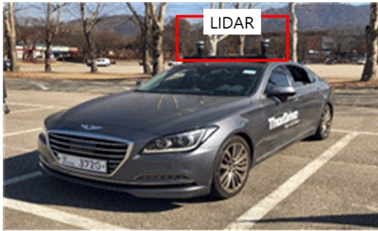
그림 4.1 라이다가 장착된 자율주행차량(좌)과 거리 센서 설치 환경(우)
