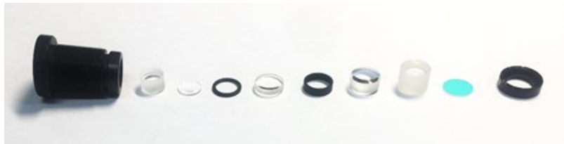
그림 3.25 카메라 광학계의 렌즈부 부품. 좌측부터 순서대로 경통, 렌즈 1, 렌즈 2, 1번 스페이서, 렌즈 3, 2번 스페이서, 렌즈 4, 렌즈 5, 적외선 필터, 하단의 고정을 위한 기구물
