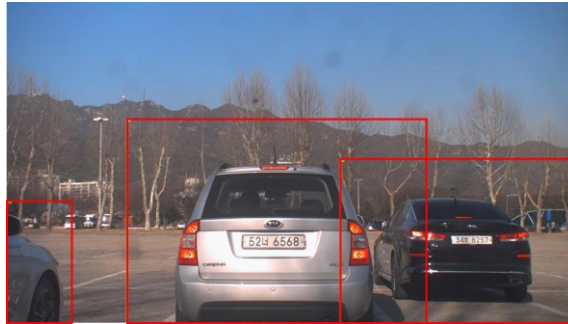
그림 4.11 YOLO—v2 디텍터를 사용하여 검출된 차량 영역
