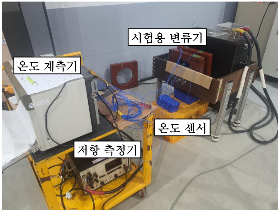
그림 5.6. 온도 시험 세트
