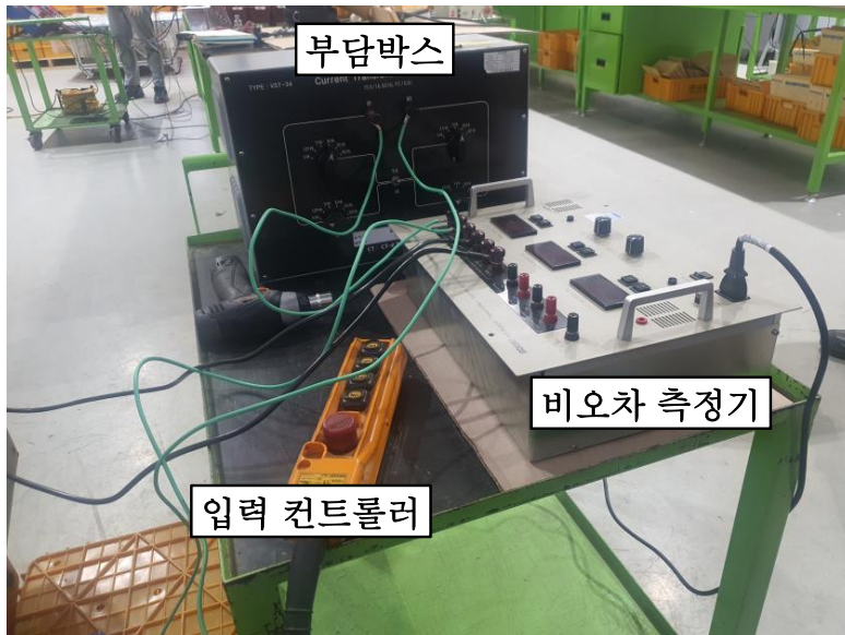
그림 5.4. 부담 박스와 비오차 측정기, 입력 컨트롤러
