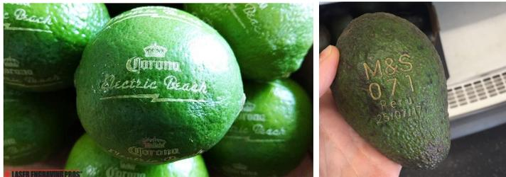
[그림 30] 레이저 옛칭(laser etching)
