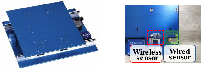
Fig. 3.3. Shaking table: QUANSER's Shaker2
