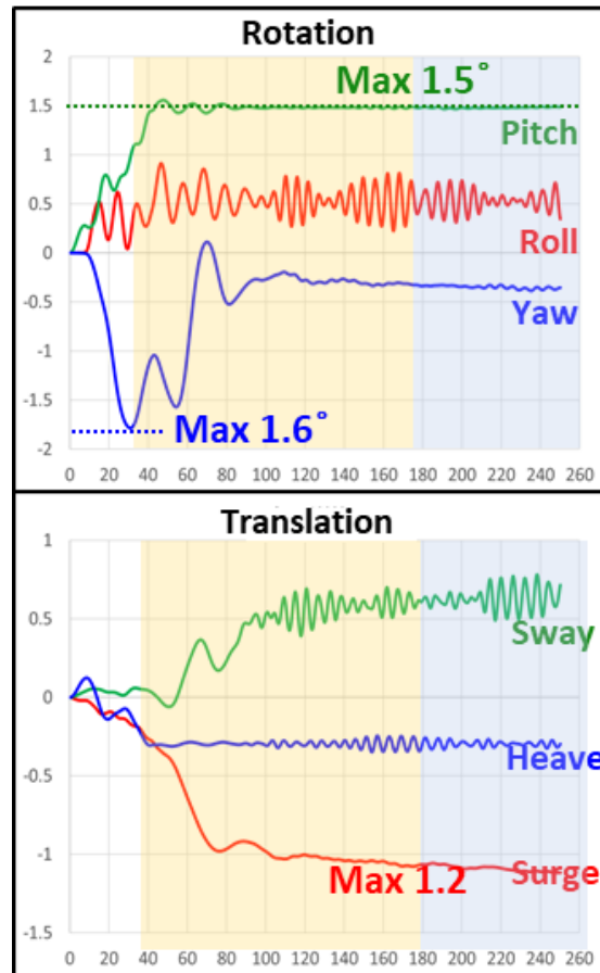
Fig. 4-20. 10,000톤 해상 크레인 움직임 분석 결과 (Case 3)
