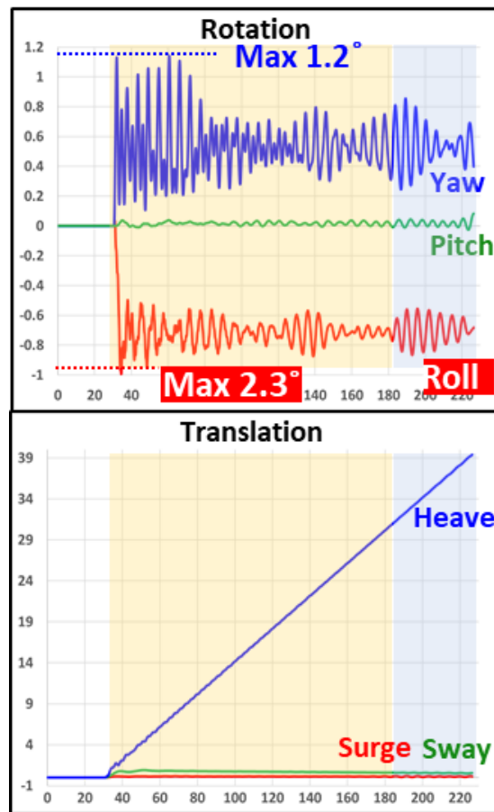
Fig. 4-27. 침몰 선체 움직임 분석 결과 (Case 5)
